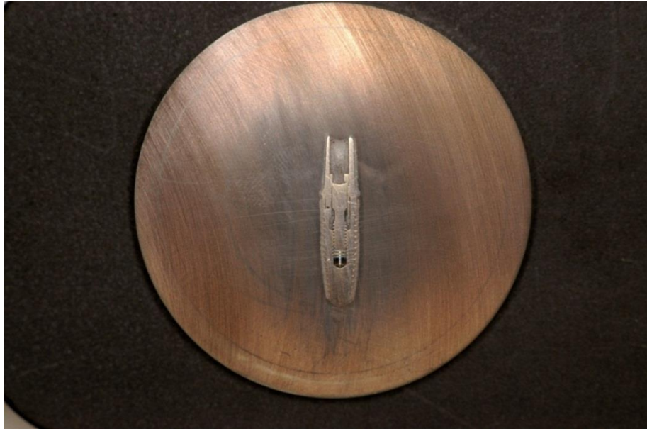
FIGURA 4 - Conjunto embutido na resina, após polimento e tratamento no metalizador.
