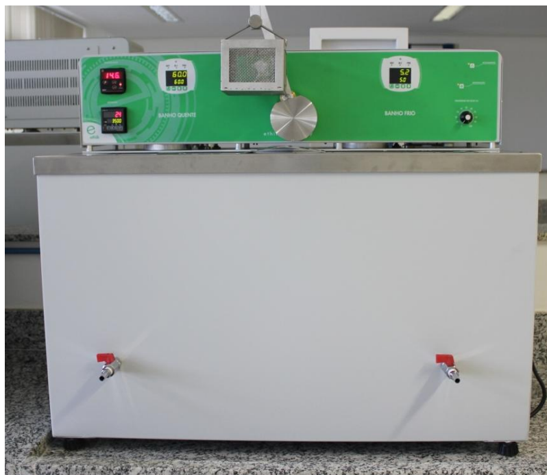
Figura 38 – Máquina de termociclagem (Ethik Technology) - Universidade Federal de Juiz de Fora.
