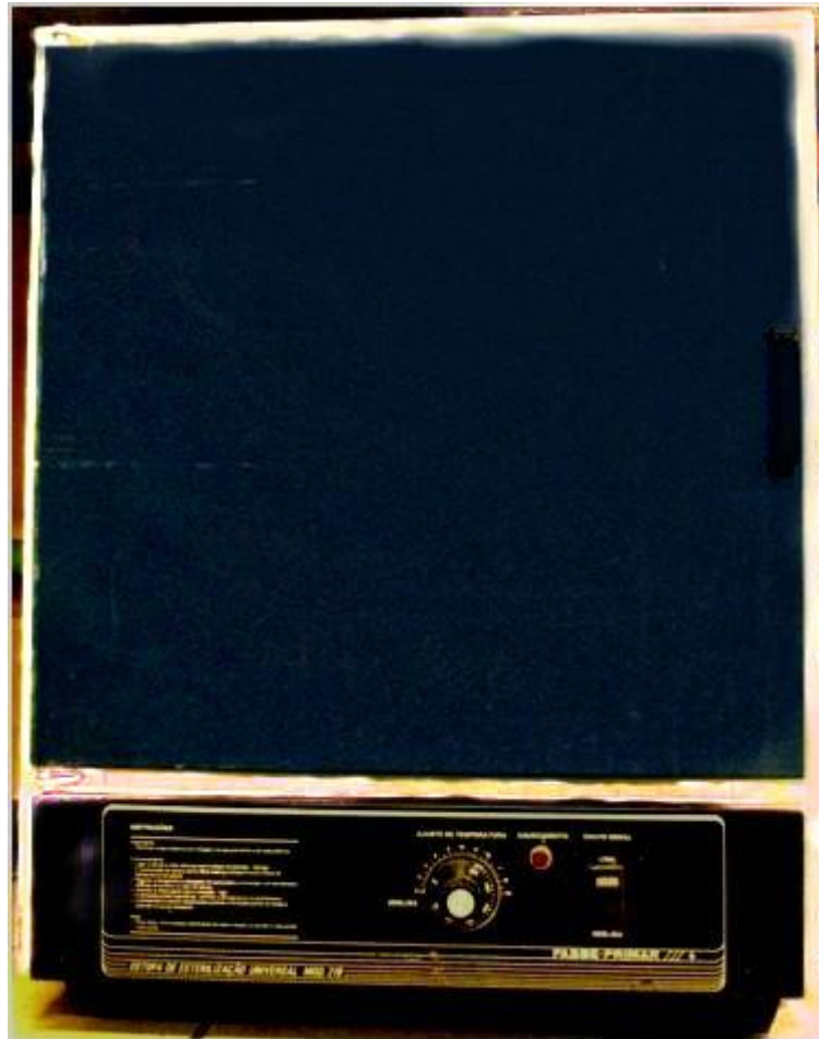
Figura 12 – Estufa de Esterilização Universal (Fabber-Primar) em temperatura de 100^{\circ}\text{C} \pm 5 .
