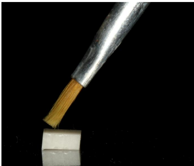
Figura 9 – Limpeza com pincel dos sais formados pelo condicionamento ácido.
