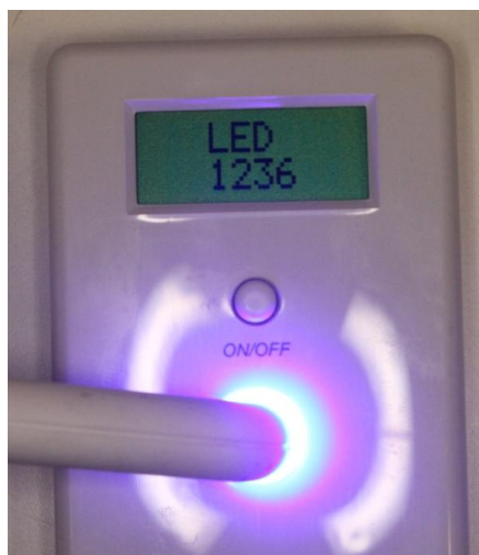
Figura 17 – Potência do LED em 1236mW/cm².
