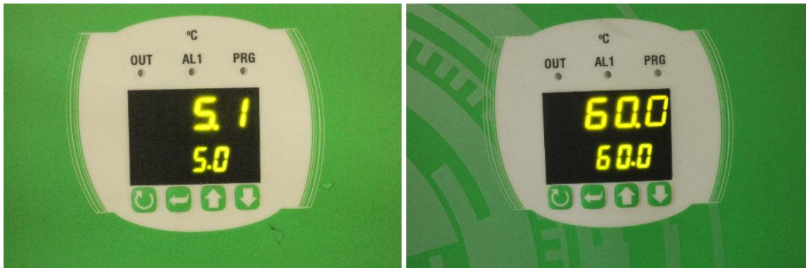
Figura 40 – Temperaturas dos banhos durante a termociclagem.
