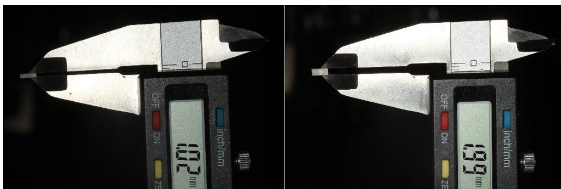
Figura 4 – Paquímetro digital medindo os CP de porcelana.
