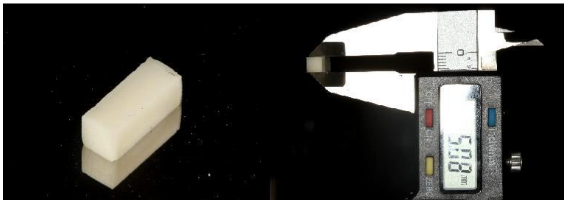
Figura 2 – Blocos de porcelana feldspática VITA VM7 confeccionados com 5x5x10mm.
