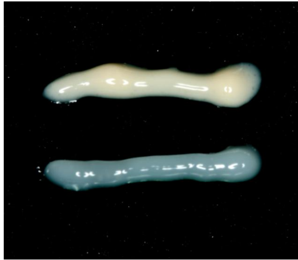
Figura 36 – Cimento disposto em uma placa de vidro, antes da manipulação.
