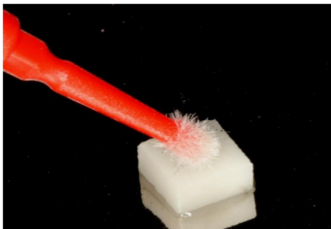
Figura 14 – Aplicação do adesivo Scotchbond Multi-Purpose (3M/ESPE).
