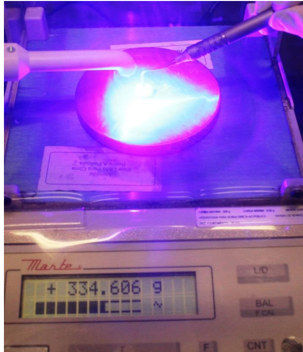
Figura 30 – Aplicação da carga entre 300g e 350g e fotoativação.
