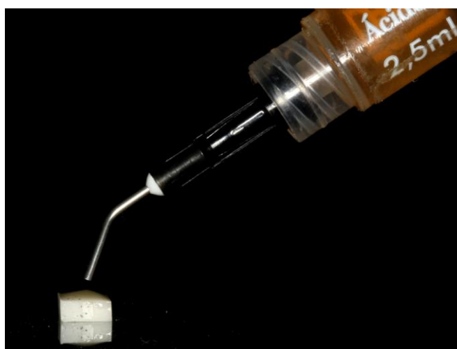
Figura 7 – Aplicação do ácido fluorídrico por 90 segundos em uma das faces do CP de porcelana.
