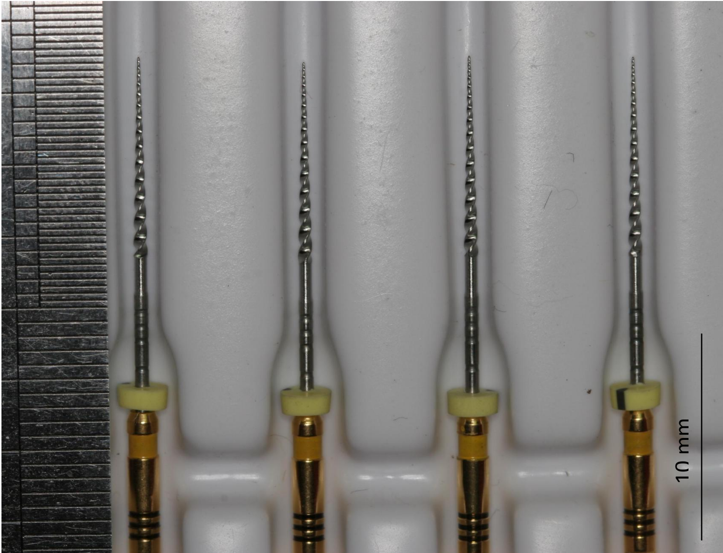
FIGURA 13 - Fotografia dos instrumentos para análise da uniformidade dimensional. FONTE: Da autora
