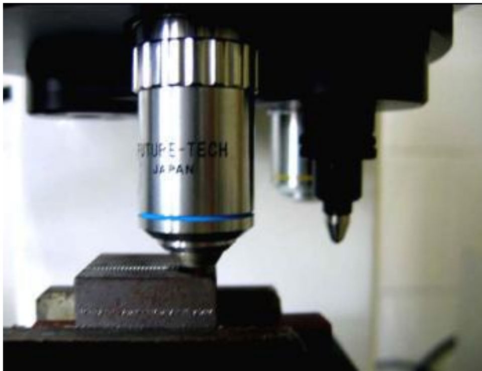
FIGURA 24 - Detalhe da amostra posicionada durante o ensaio de Microdureza Vickers .
