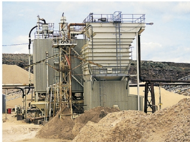
Figura 3.15: Modelo LT de Espessador de Lamelas (METSO, 2006).
