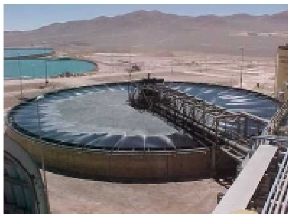
Figura 3.13: Espessador de Alta Escala, Escondida, Chile (DELKOR).
