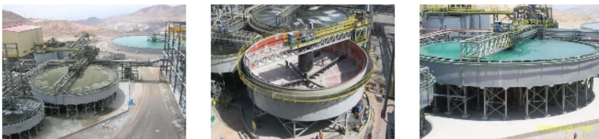
Figura 3.12: Espessador de Alta escala Cerro Verde Peru (DELKOR).
