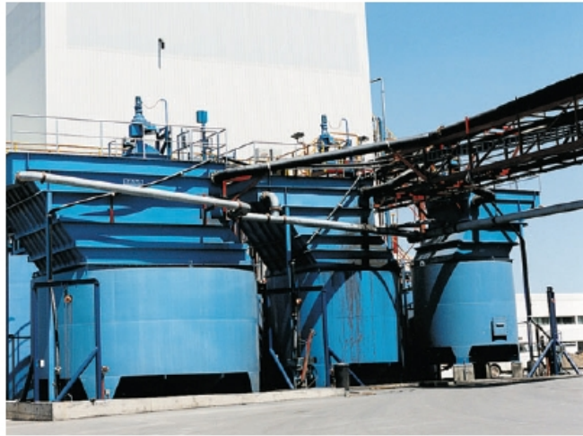
Figura 3.17: Modelo LTK de Espessador de Lamelas (METSU, 2006).
