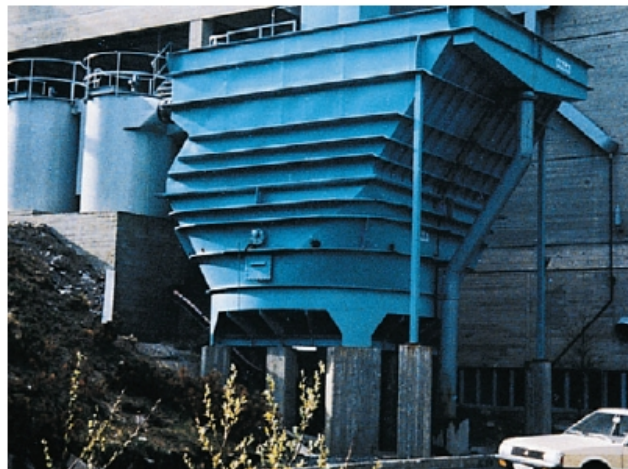
Figura 3.16: Modelo LTS de Espessador de Lamelas (METSO, 2006).
