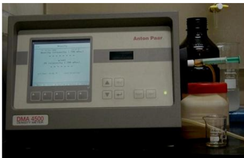
Figura 12 – Equipamento de medição da massa específica.
