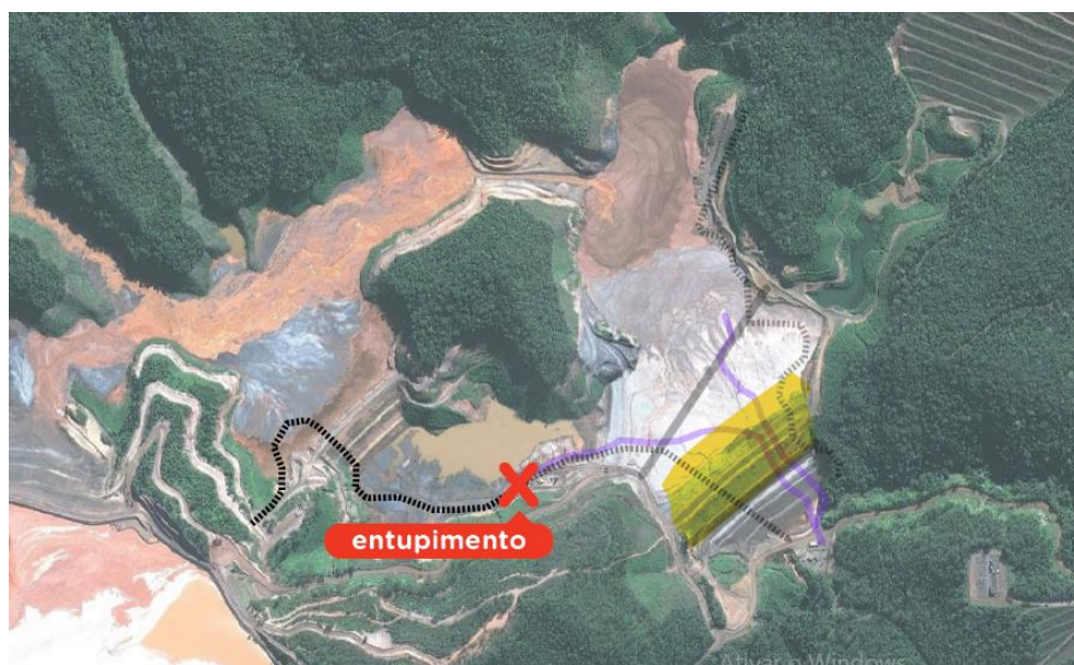
Figura 44: Ilustração sobre imagem de satélite indica local de aparecimento do vórtice indicando penetração de rejeitos na galeria principal no reservatório do Dique 1. Fonte: Nexojornal.
