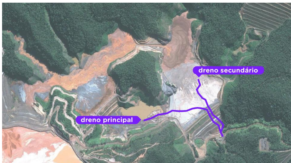
Figura 33: Representação dos drenos de fundo principal e secundário. Fonte: Nexojornal.
