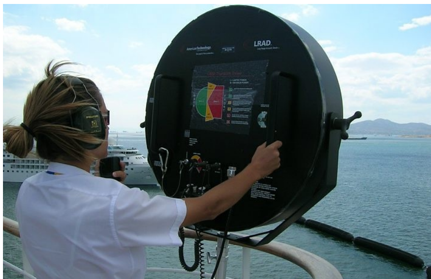
Figura 4 – LRAD: Modelo de arma não-letal baseada na energia acústica
