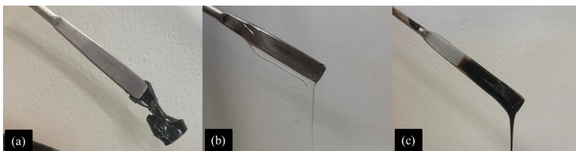
Figura 29: Comparação visual da viscosidade do bio-óleo destilado (a), óleo de mamona (b) e bio-óleo modificado (c), evidenciando as alterações na viscosidade após a modificação do bio-óleo.
