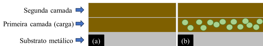
Figura 46: Representação das duas camadas de revestimentos nos sistemas sem microcápsulas (a) e com 10% ou 20% de microcápsulas (b).
