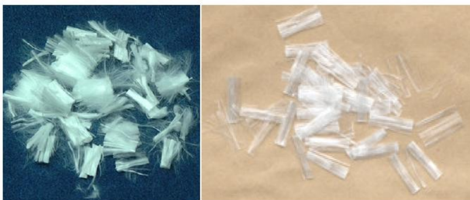
Figura 18 - Fibras de vidro e nylon de alto módulo para adição em concretos Fonte: www.piniweb.com.br , 2015
