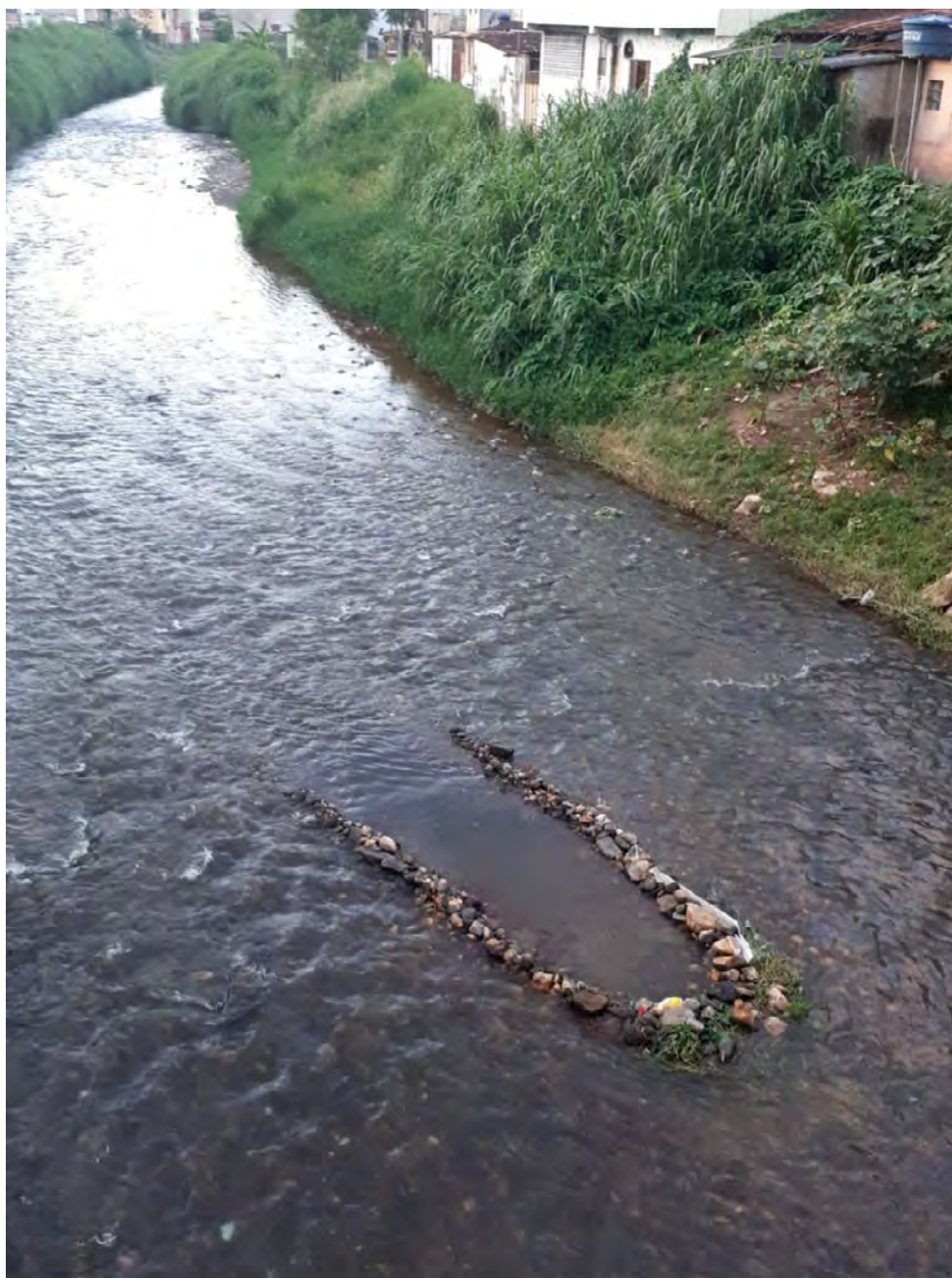
Figura 46 - Indícios da “ferradura” ou canoa para reter o ouro Fonte: Repertório do autor
