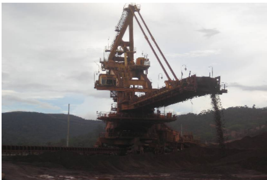
Figuras 27 Empilhadeira de minério
