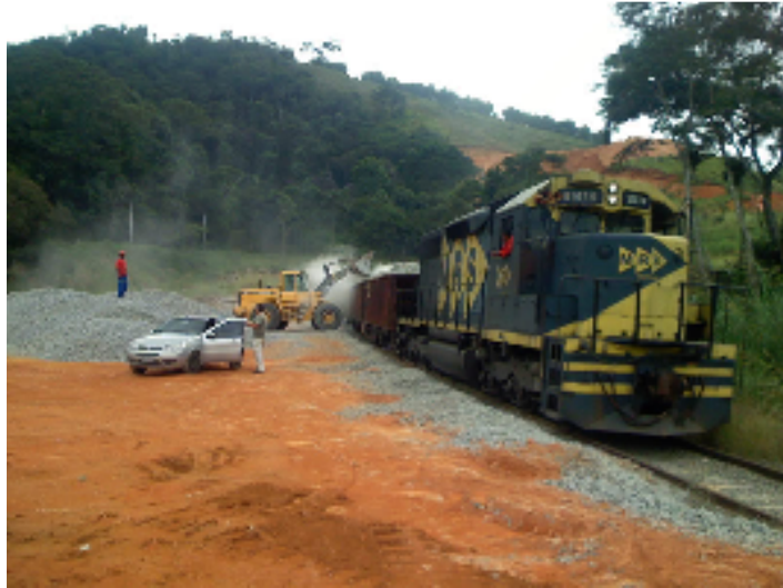
Figura 28 Carregadeira de pneus carregando trem de transporte de minérios
