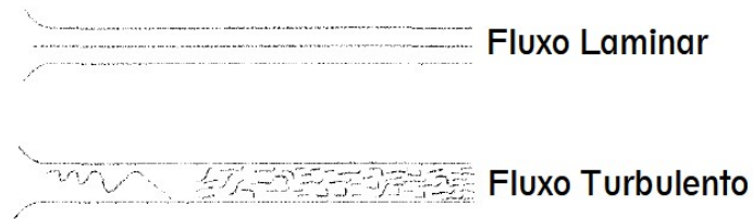
Figura 21 – Comparação entre os regimes de escoamento laminar e turbulento. Fonte: Adaptado Coulson et al. (1999).
