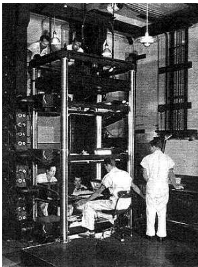
Fig. 108 – Disney – Câmera Multiplano em uso nos estúdios. FONTE – MALTIN, 1987, p. 52.
