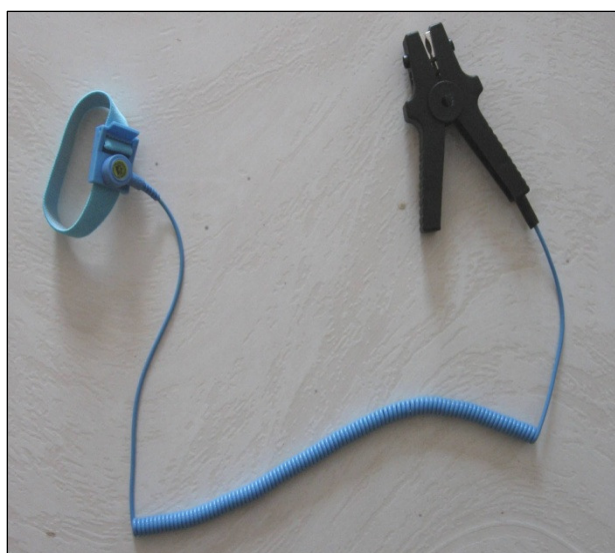
FIGURA 4.16 – Pulseira com resistores e garra jacaré
