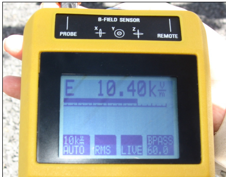
FIGURA 5.5 – Vista em detalhe do painel da unidade de aquisição das medições
