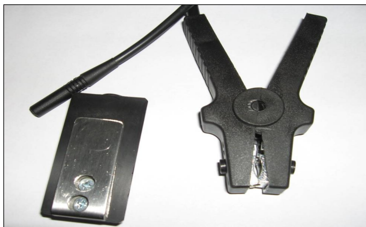
FIGURA 4.19 – Detalhe do Clipe de cintura com garra jacaré e pino banana
