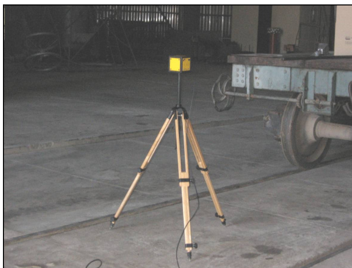
FIGURA 5.6 – Medição do campo elétrico – Sensor de campo sobre tripé a 1 m do solo
