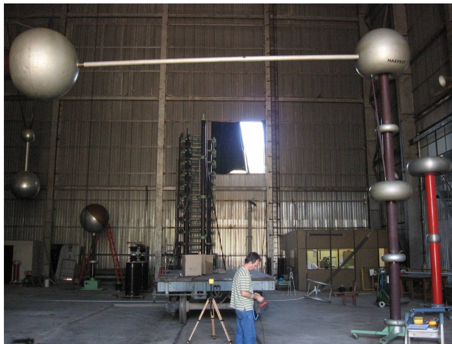
FIGURA 5.4 – Vista geral do arranjo do LEAT para medições de campo elétrico
