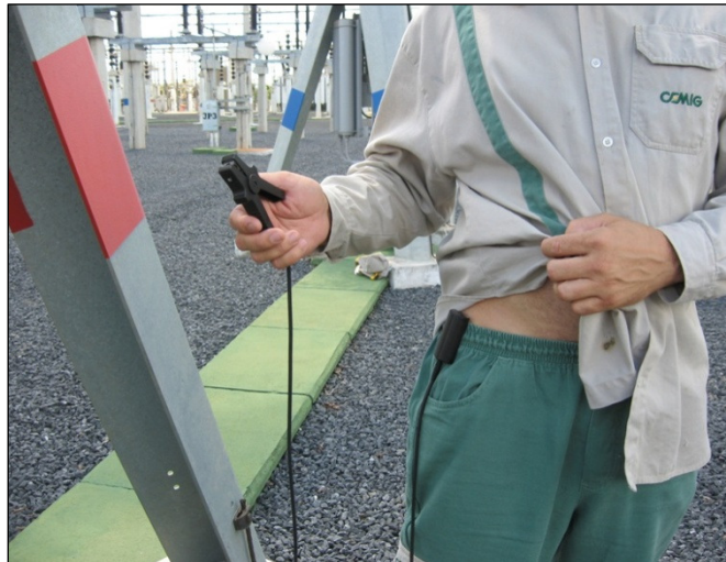
FIGURA 4.20 – Clipe de cintura com garra jacaré em uso
