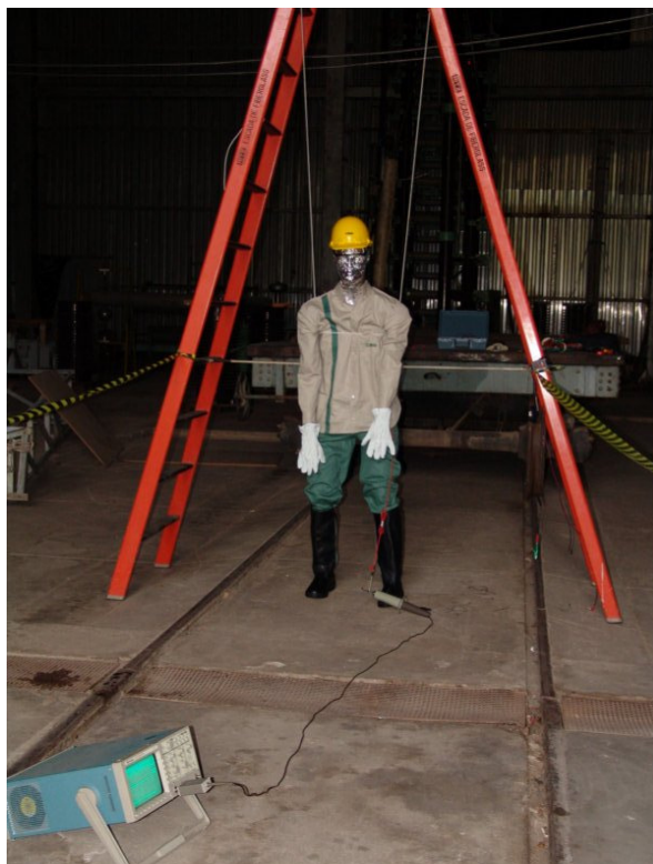
FIGURA 4.24 – Manequim com uniforme e bota - medição de tensão e corrente
