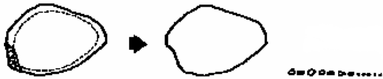
Figura 3.4 - Esquema de fratura por Cisalhamento (Abrasão). Kelly e Spottiswood (1982)
