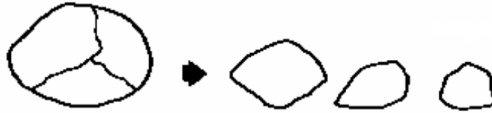
Figura 3.2 - Esquema de fratura por compressão. Kelly e Spottiswood (1982)
