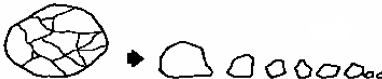
Figura 3.3 - Esquema de fratura por choque ou impacto. Kelly e Spottiswood (1982)
