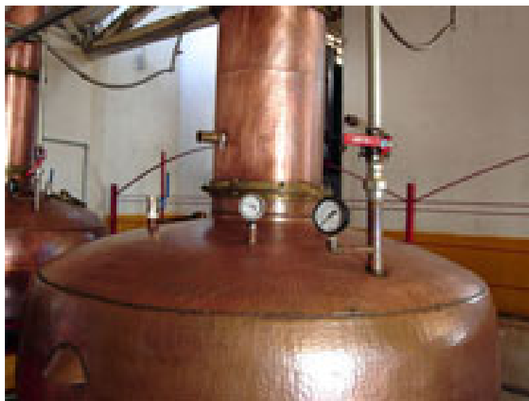
Figura 4 - Destilador de cobre utilizado na produção de cachaça artesanal. Fonte: SEBRAE
