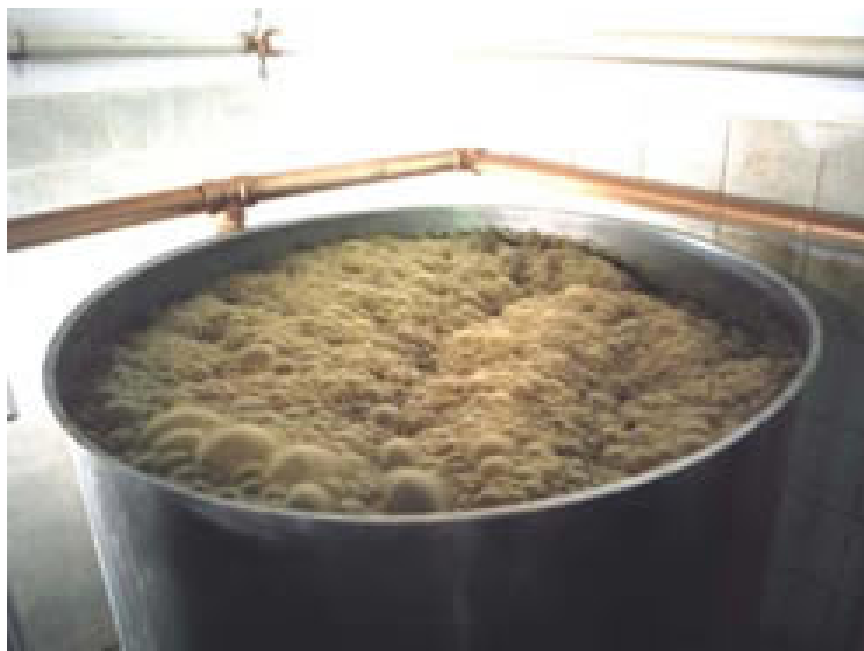
Figura 3 - Modelo de dorna de fermentação construída em aço inoxidável. Fonte: SEBRAE
