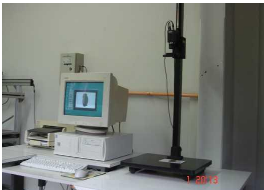
Figura 16 – Equipamento desenvolvido para determinação do avanço da corrosão (Alvarenga, 2007).
