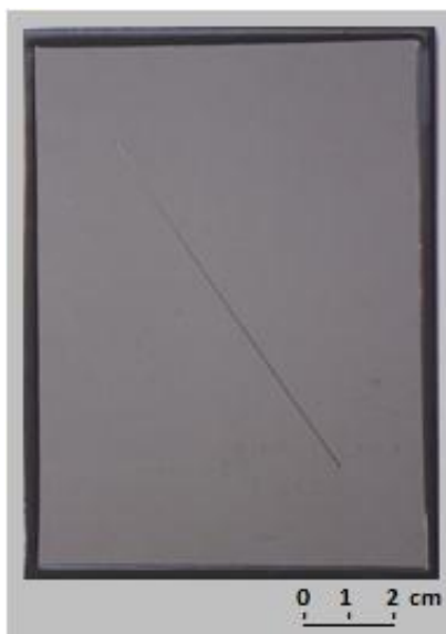
Figura 11 – Aspecto do corpo de prova com risco antes do teste de corrosão.
