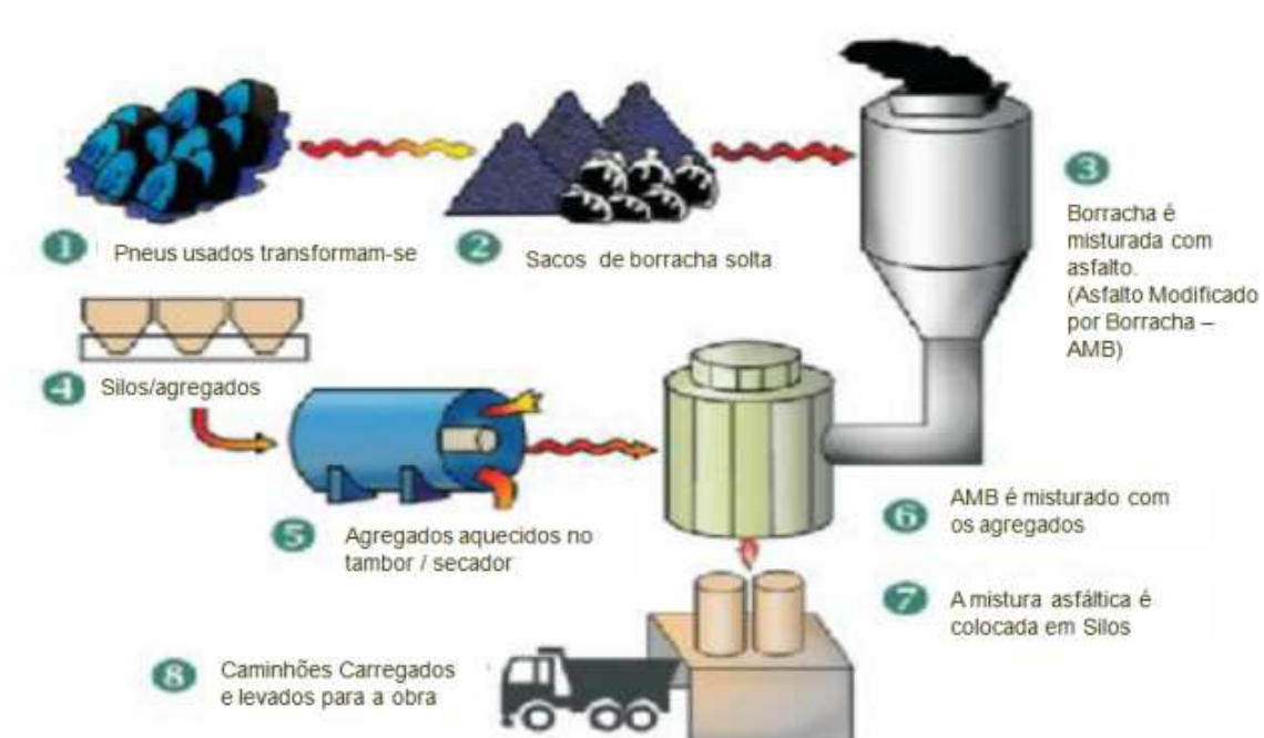
Figura 14 – Processo de mistura estocável do asfalto-borracha.
