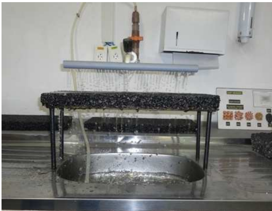
Figura 8 – Demonstração da permeabilidade do Asfalto Borracha.
