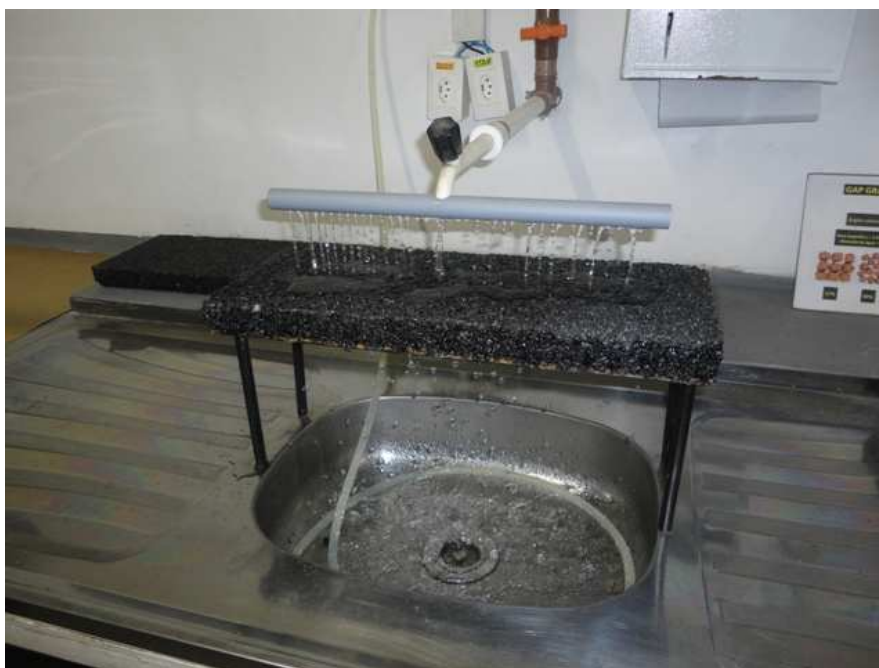
Figura 7 – Permeabilidade do Asfalto Borracha.
