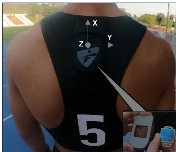
Figura 4.2 – Utilização da UMI: colete de poliamida para acomodação do sensor (WT901SDCL, Wit - Motion, Shenzhen, China).
