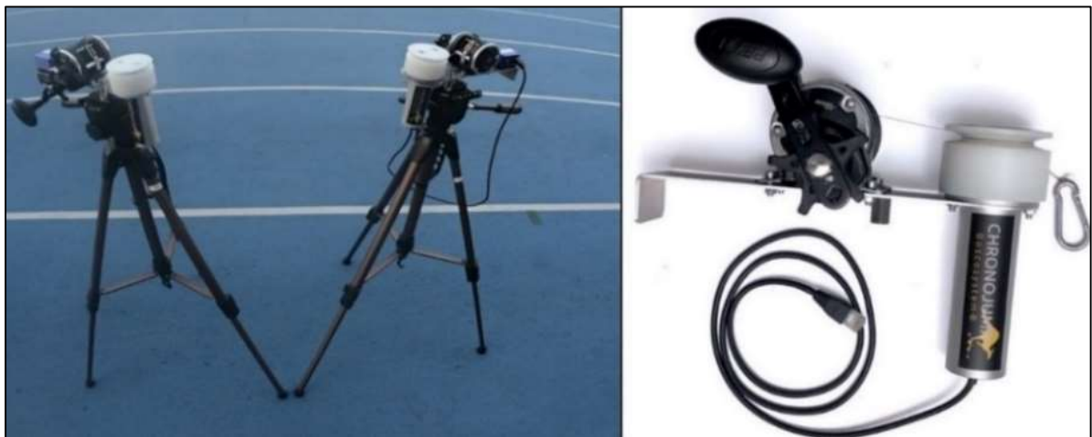
Figura 2.2 – Dispositivo para medição de variáveis biomecânicas de sprints Race encoder ®.
