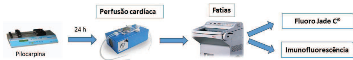
Figura 7: Desenho experimental da perfusão cardíaca e obtenção de fatias em criostato para realização de imunofluorescência e determinação de neurônios em processo de degeneração.
