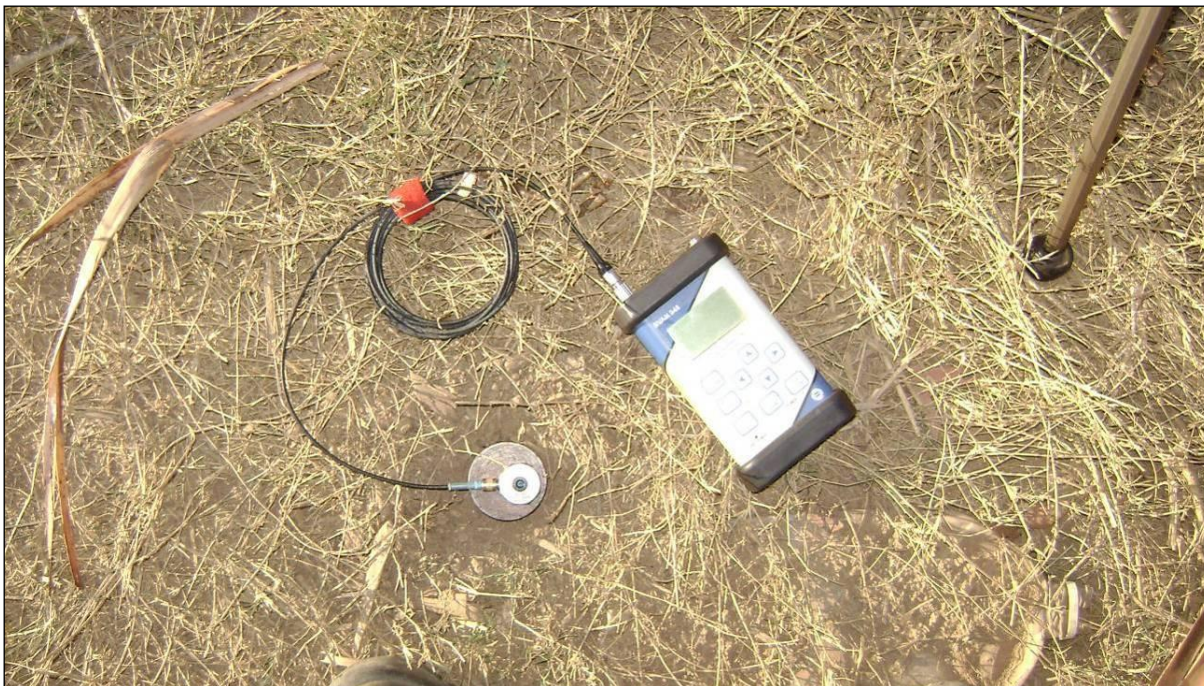
Figura 5: Acelerômetro triaxial afixado ao solo e medidor de vibração em um ponto de medição
