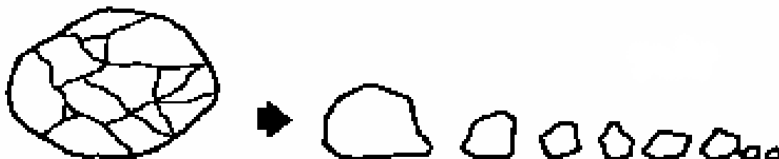
Figura 3 Esquema de fratura por impacto. Kelly e Spottiswood (1982).
