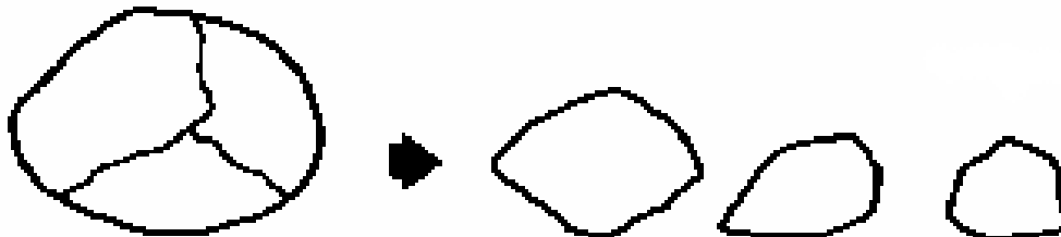
Figura 2 Esquema de fratura por compressão. Kelly e Spottiswood (1982).
