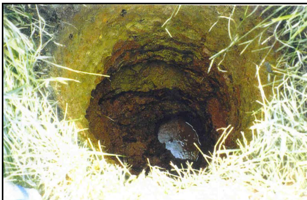
Figura 1.8 – Início da elevação do nível d'água no poço número 1, podendo-se notar a saída de bolhas de ar aparentando processo de “ebulição”
