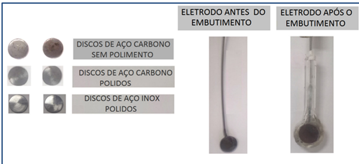
Figura 5.2 - Etapas de construção do eletrodo: discos sem polimento, discos polidos, disco soldado à haste metálica e eletrodo após o embutimento.
