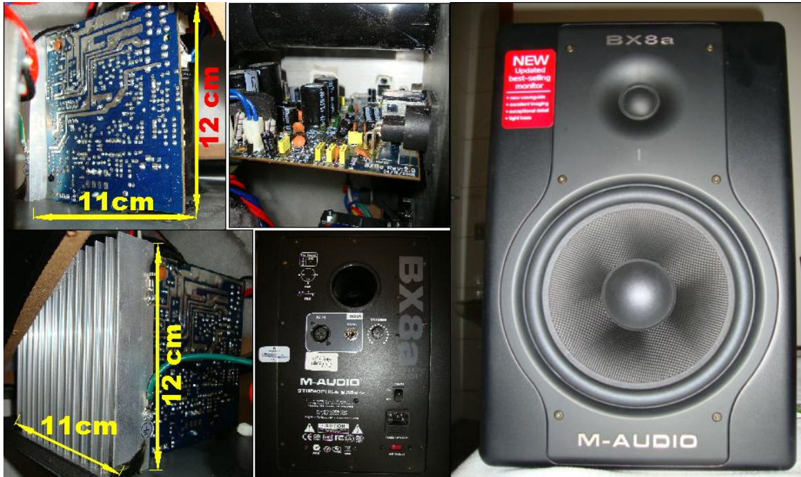
Figura 2.1 – Amplificador classe AB bi-amplificado (60+70Watts)
