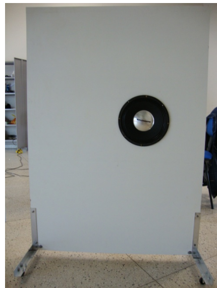
Figura 4.2 - Confeção do Baffle
