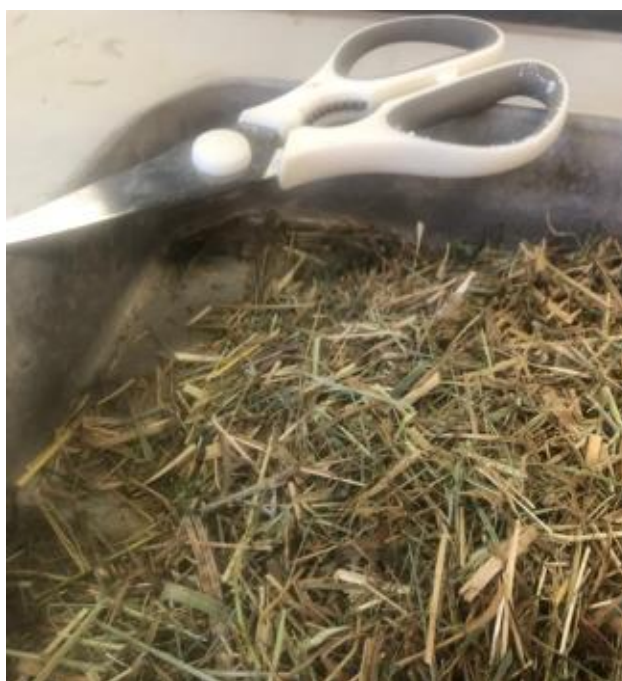
Figura 43. Preparação das fibras vegetais cortadas com no máximo 3 cm de comprimento.
