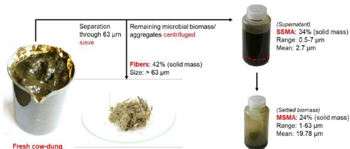
Figura 28: Extração de componentes a partir de excremento bovino fresco. As frações SSMA e MSMA são de aglomerados microbianos de tamanho pequeno e médio respectivamente, do inglês small-sized microbial aggregates (SSMA) e medium-sized microbial aggregates (MSMA), respectivamente. Fonte: Kulshreshtha et al. (2022).
