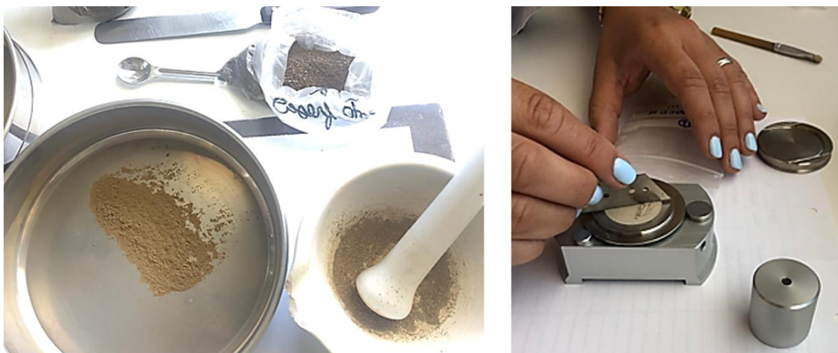
Figura 32. Preparação das amostras para o ensaio de Difração por Raios-X (DRX).
