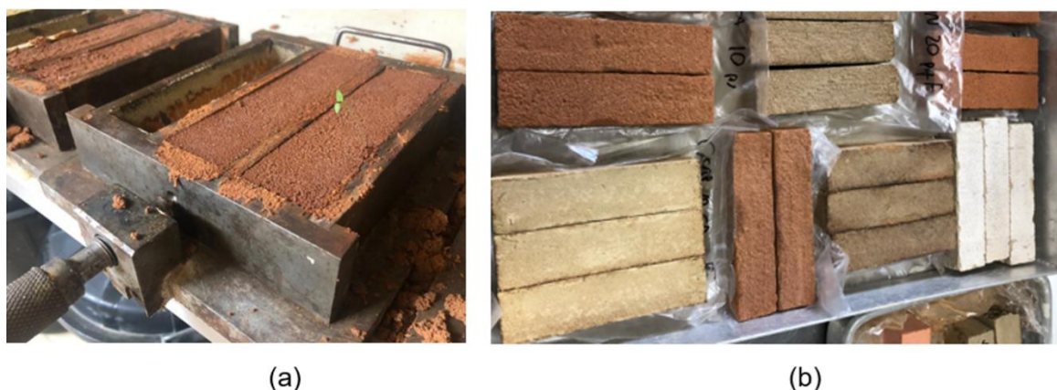
Figura 45. CP prismáticos: (a) secando na forma e (b) já fora da forma.
