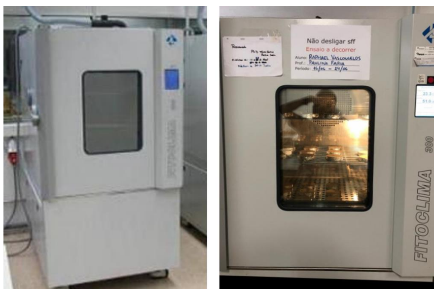
Figura 57. Câmara Climática Aralab Fitoclima 300 EDTU utilizada no ensaio para avaliação da higroscopicidade.
