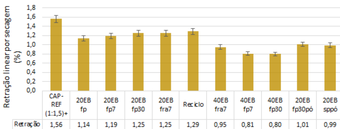
Figura 74. Retração linear por secagem das argamassas CAP(1:1,5) sem e com adições de diferentes amostras de EB avaliadas: média e desvio padrão.
