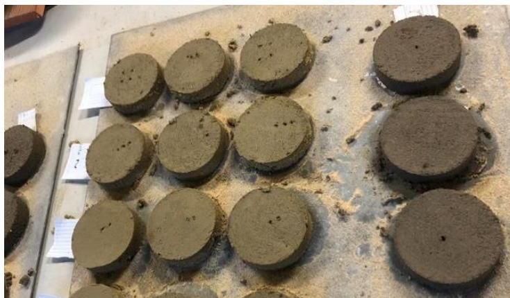
Figura 47. CP com forma de bolacha cilíndrica secando na bandeja metálica de apoio.
