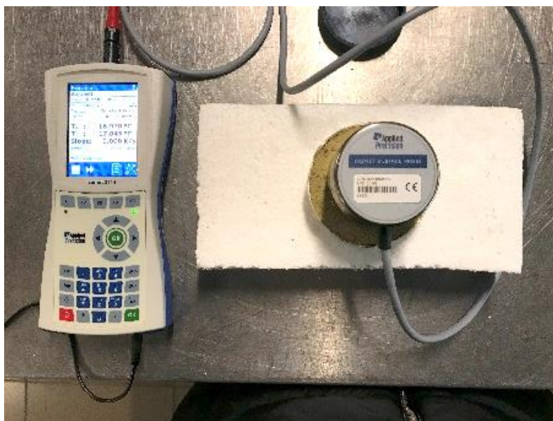
Figura 50. Ensaio para medir a condutibilidade térmica com o equipamento ISOMET 2104 (Heat Transfer Analyser) sendo realizado no corpo de prova com forma de bolacha cilíndrica.
