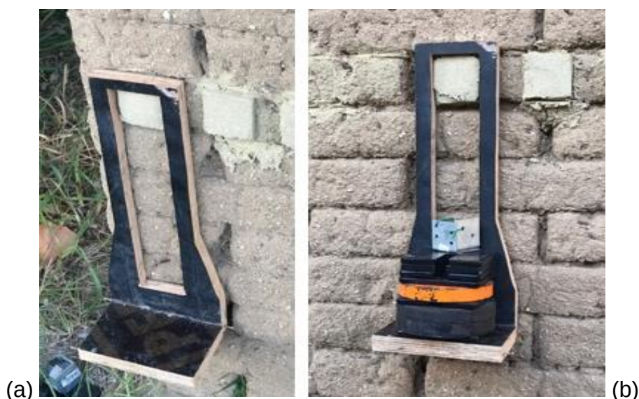
Figura 53. Dispositivo fabricado artesanalmente para realização do ensaio de resistência de aderência ao cisalhamento, suspenso num CP (a) e objetos de massa conhecida colocados progressivamente no dispositivo, antes de se atingir a rotura (b).
