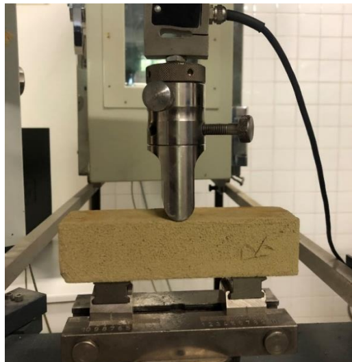
Figura 51. Ensaio de resistência a flexão sendo realizado com CP prismático de argamassa.
