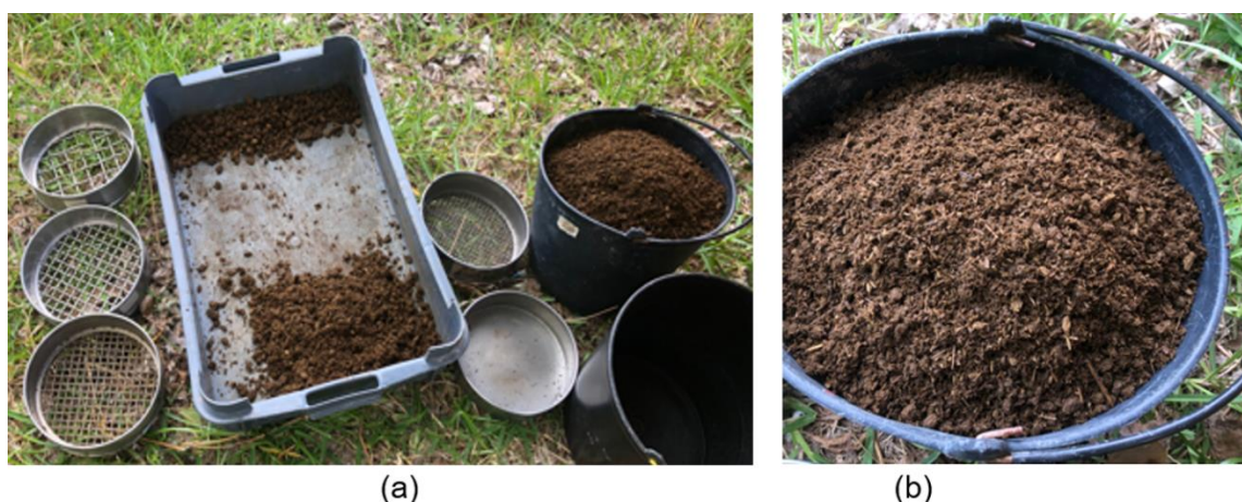
Figura 40: Excremento compostado por 7 dias sendo peneirado em diversas malhas (a) e depois de peneirado na malha # 2,79 mm (b).
