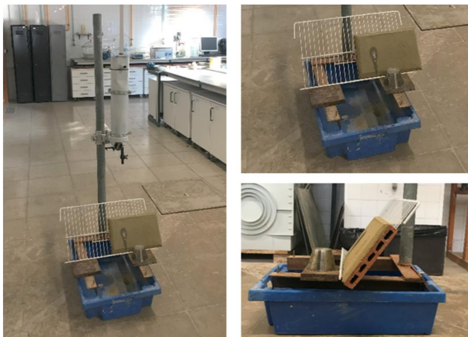
Figura 56. Ensaio de erosão por gotejamento sendo realizado - Geelong drip test .
