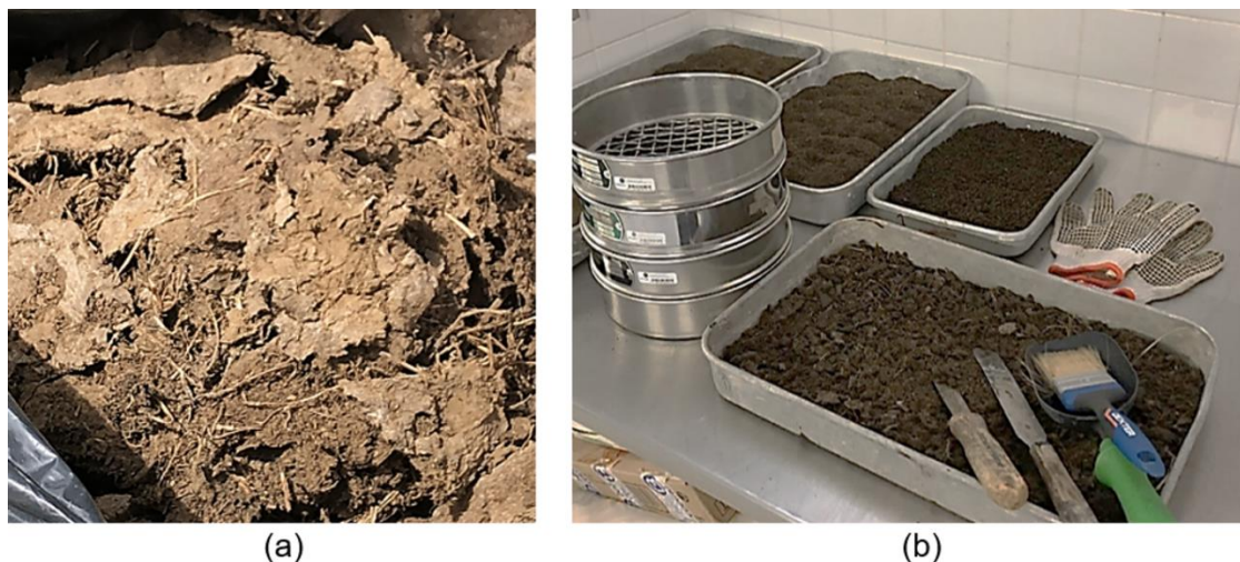
Figura 42. Excremento coletado seco e endurecido no pasto (a) e processo de desagregação manual e peneiramento para caber no moinho elétrico (b).
