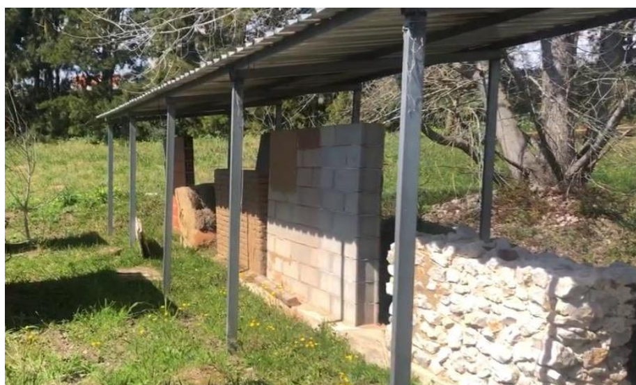
Figura 49. Diferentes alvenarias, cobertas, para experimento com revestimentos, localizadas na Estação Experimental de Exposição Natural de Revestimentos, CERIS-NOVA.
