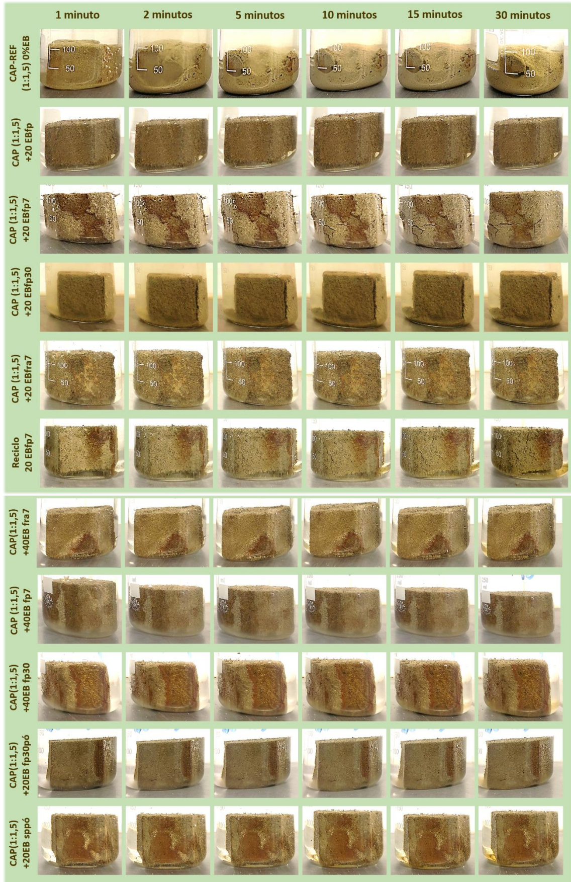
Figura 78. Corpos de prova das argamassas de terra CAP(1:1,5) sem e com adição de diferentes proporções e tipos de EB após imersão em água por até 30 minutos.
