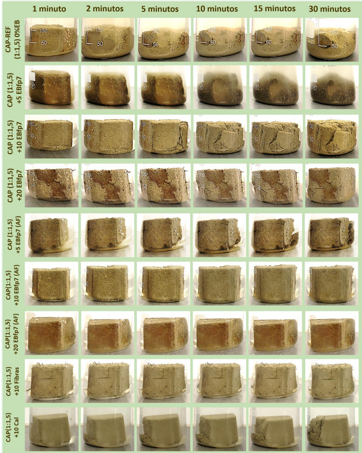
Figura 86. Imersão em água por até 30 minutos da argamassa de referência, CAP-REF (1:1,5), das argamassas com adição de 5%, 10% e 20% de EBfp7 fermentadas e não fermentadas, e das argamassas com adição de 10% de Fibras e de 10% de Cal.
