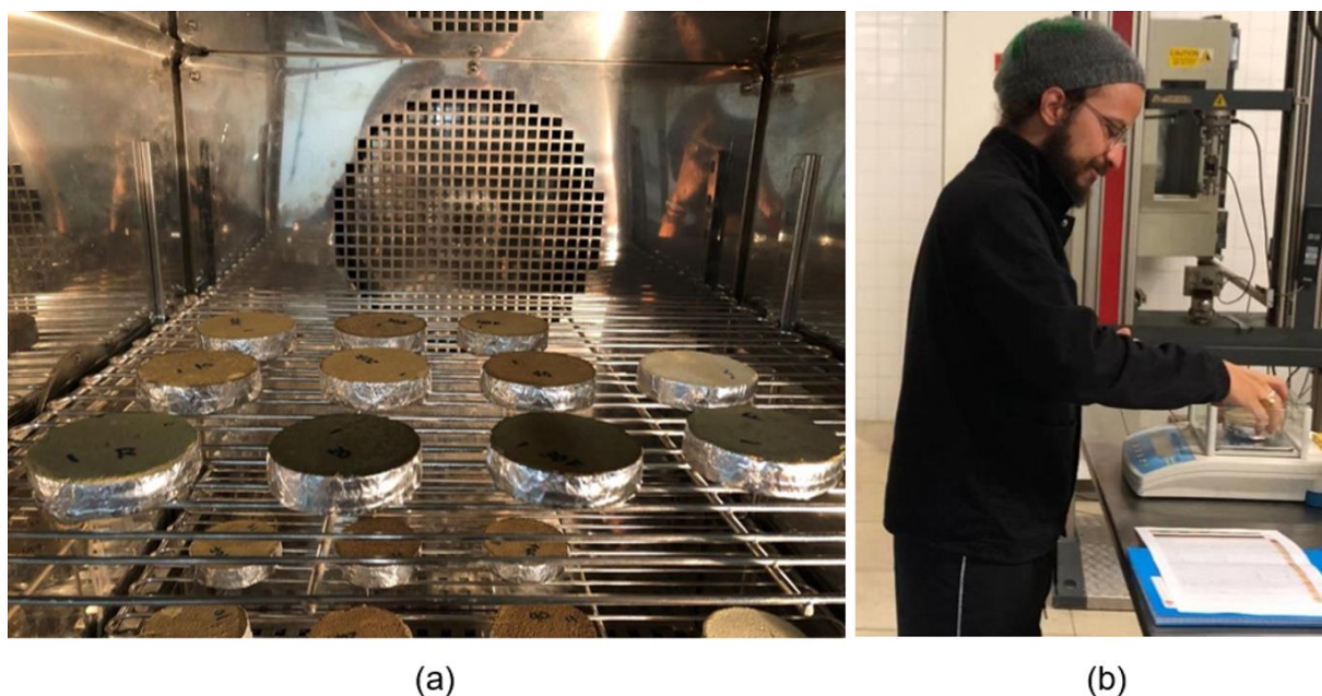
Figura 58. CP com a lateral e fundo impermeabilizados sendo ensaiados dentro da câmara climatizada (a) e sendo pesados (b).
