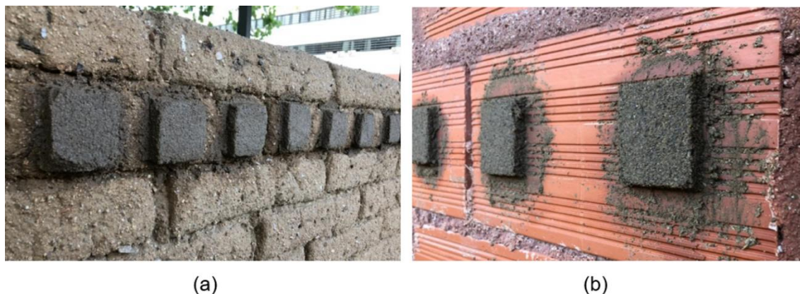
Figura 48. CP de reboco aplicados em duas alvenarias: adobe e tijolo cerâmico.
