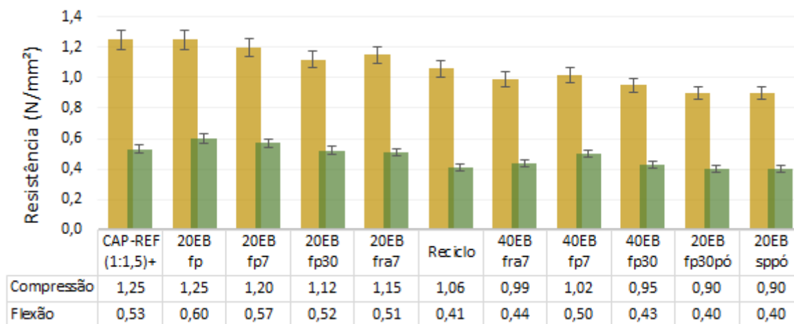
Figura 76. Resistências à compressão e flexão das argamassas CAP(1:1,5) sem e com diferentes teores e tipos de EB avaliadas: média e desvio padrão.
