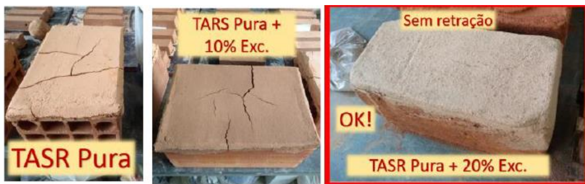
Figura 60. Efeito causado pela adição de 20% excremento bovino compostado por 18 dias, na terra TASR sem adição de areia. Nascimento, 2020.
