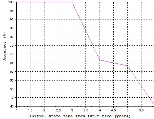
Figura 4-8: Acurácia do sistema de prognósticos em relação ao tempo transcorrido entre o estado inicial e o estado de falha.
