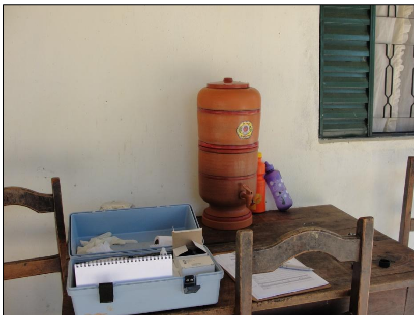
Figura 11 - Análise de turbidez in loco no filtro de barro com velas de cerâmica distribuído na comunidade. Foto: O autor
