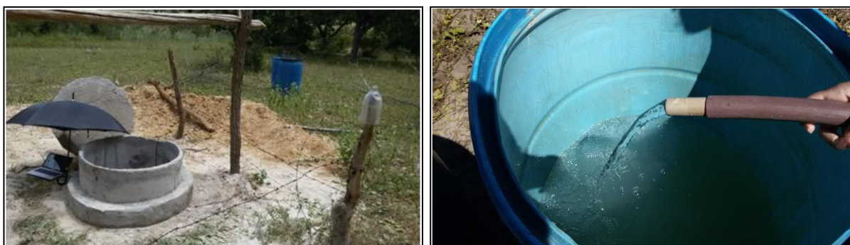
Figura 36 – Teste de vazão sendo realizado no poço escavado em Riacho (esquerda) e qualidade da água fornecida pelo poço (direita). Fotos: Allyson S. R. Silva
