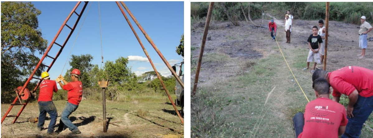
Figura 35 – Sondagem do solo à percussão realizada na comunidade de Lagedo com acompanhamento de moradores locais e da equipe da UFMG. Fotos: Delmo R. Vilela
