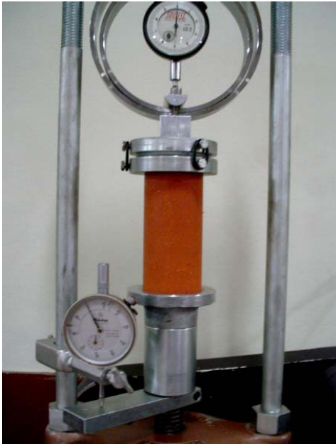
FIGURA 26 – Ensaio de compressão simples em corpos-de-prova de solo Laboratório de Geotecnia – Escola de Engenharia – UFMG
