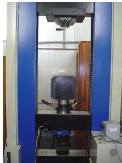
FIGURA 12 – Máquina universal com capacidade de 300 kN LAEES – Escola de Engenharia – UFMG
