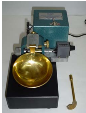
(b) Aparelho de Casagrande elétrico e cinzel - usados no ensaio de limite de liquidez
