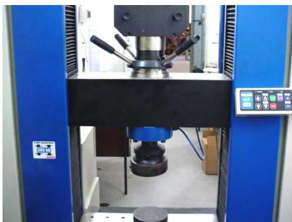
FIGURA 12 – Máquina universal com capacidade de 300 kN LAEES – Escola de Engenharia – UFMG
