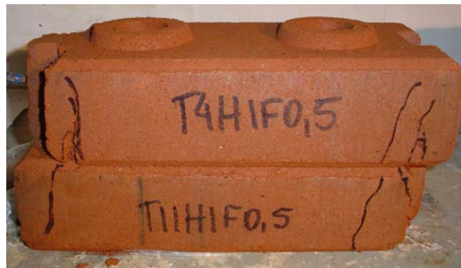
FIGURA 49 – Ruptura no prisma
