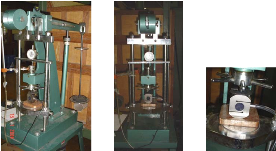
FIGURA 18 – Prensa para ensaios de adensamento Laboratório de Geotecnia – Escola de Engenharia – UFMG
