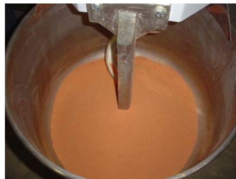
(b) Adição de solo no misturador de argamassa
