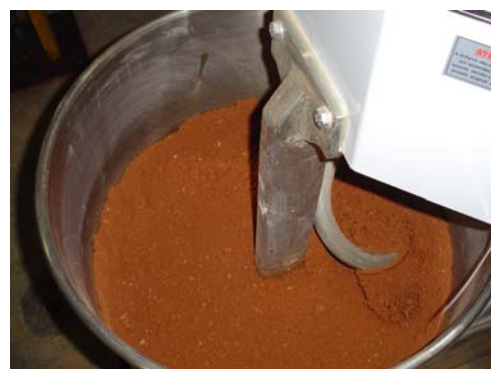
(h) 3ª homogeneização da mistura solo-cimento-resíduos de madeira
