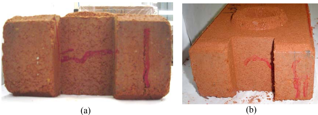
FIGURA 47 – Ruptura no tijolo – solo Homog. 01 (a) 0% resíduos (b) 1% resíduos
