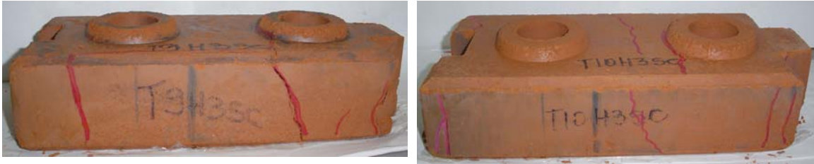
FIGURA 43 – Ruptura do tijolo – face longitudinal
