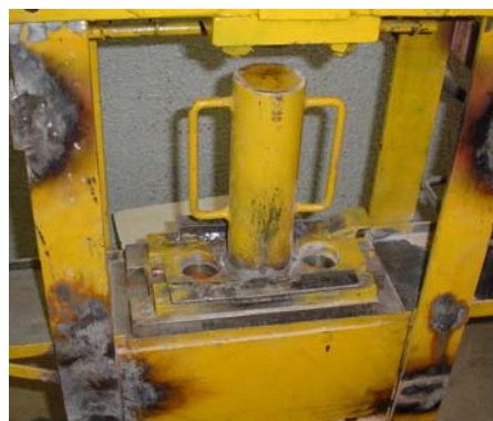
(b) Colocação da forma superior
