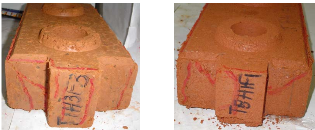
FIGURA 45 – Ruptura do tijolo – região do encaixe macho
