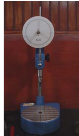
(c) Penetrômetro - usado no ensaio de limite de liquidez
