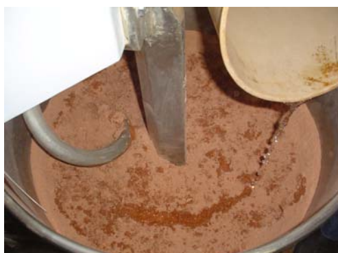
(g) Colocação da água
