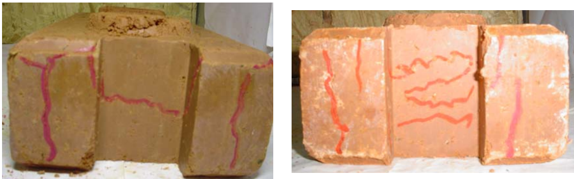
FIGURA 44 – Ruptura do tijolo – região do encaixe fêmea
