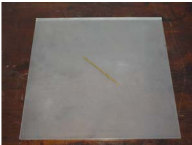
(a) Placa esmerilhada e gabarito - usados no ensaio de limite de plasticidade
