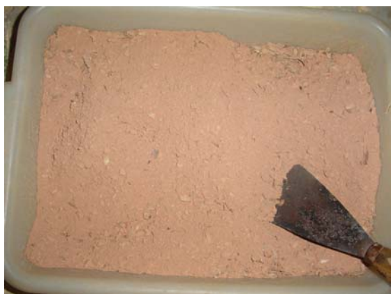
(e) 2ª homogeneização do solo, do cimento e dos resíduos
