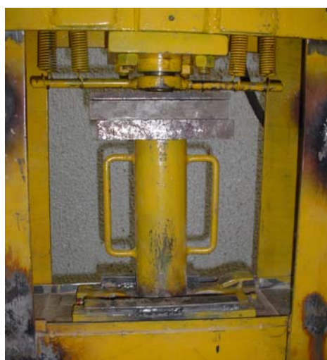
(c) Colocação das chapas auxiliares e início da prensagem do tijolo.
