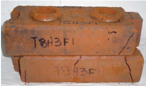
FIGURA 48 – Ruptura no prisma
