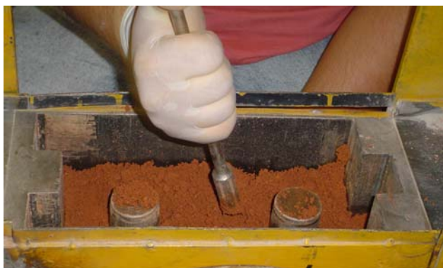
(a) Colocação da mistura na forma de tijolo e leve compactação com um soquete
