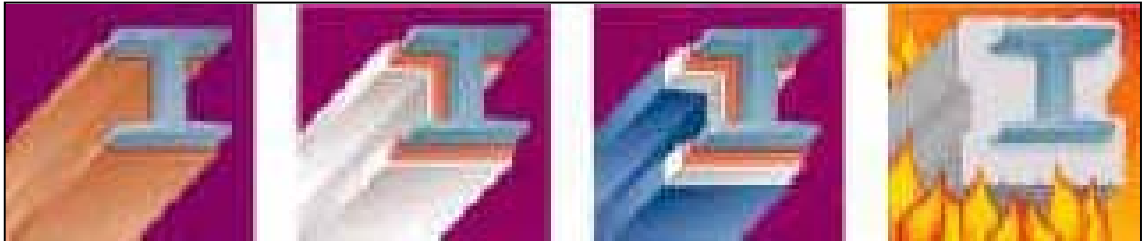
Figura 3.6 – Esquema da aplicação de uma tinta intumescente e sua expansão volumétrica em situação de incêndio.
