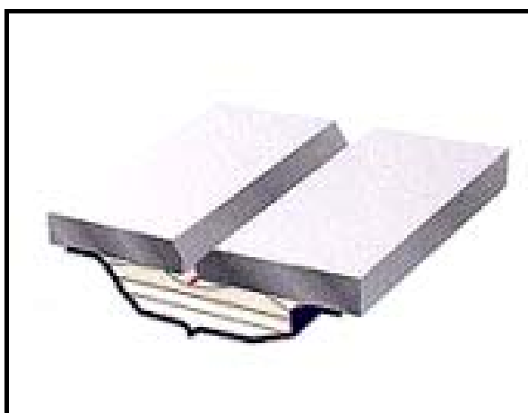
FIGURA 2.13 – Esquema de fixação do backing cerâmico com fita adesiva alumínio.
