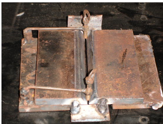
FIGURA 3.3 – Fotografia do sistema de fixação por grampos para posicionamento da amostra.
