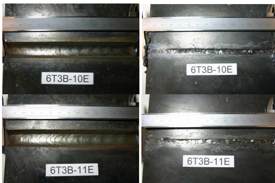
FIGURA 4.14 – Fotografia aspecto visual do acabamento da superfície do passe de raiz (esquerda) e respectivo reforço (direita). Amostras 6T3B-10E e 6T3B-11E.
