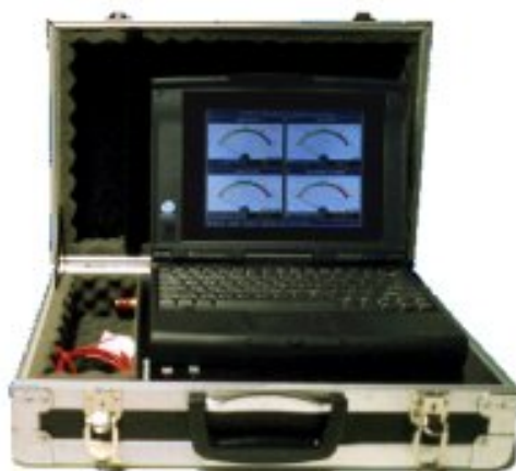
FIGURA 3.4 – Fotografia da maleta SAP-1 para aquisição de dados de soldagem
