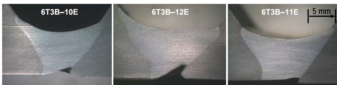
FIGURA 4.1 – Macrografias do passe de raiz com falta de fusão lateral da junta na região da raiz.
