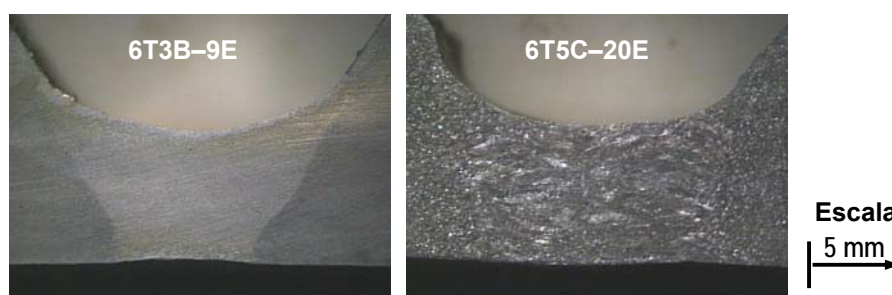
FIGURA 4.3 – Macrografia da altura do reforço do passe de raiz insuficiente.
