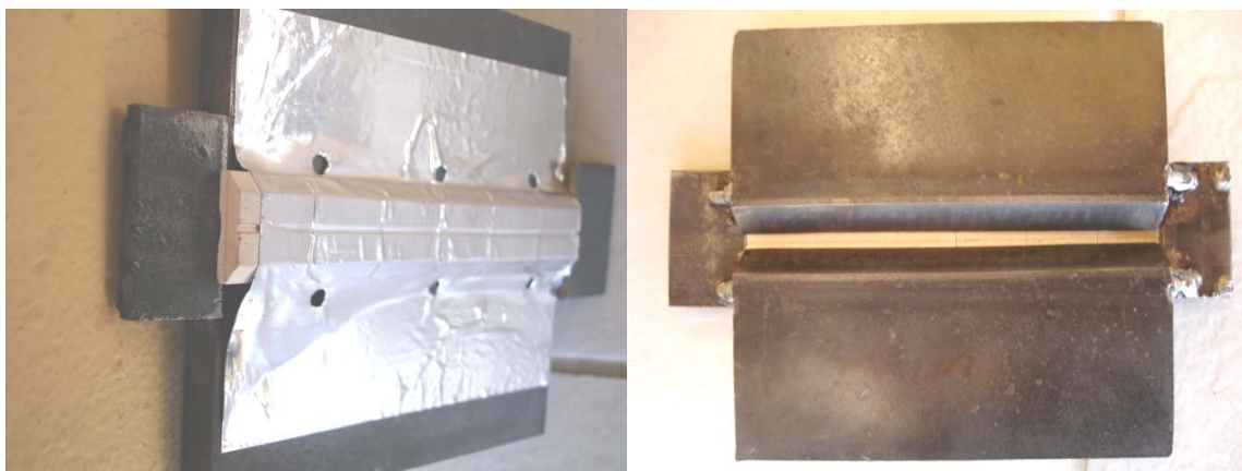
FIGURA 3.8 – Foto da amostra preparada para a soldagem unilateral FCAW do passe de raiz
