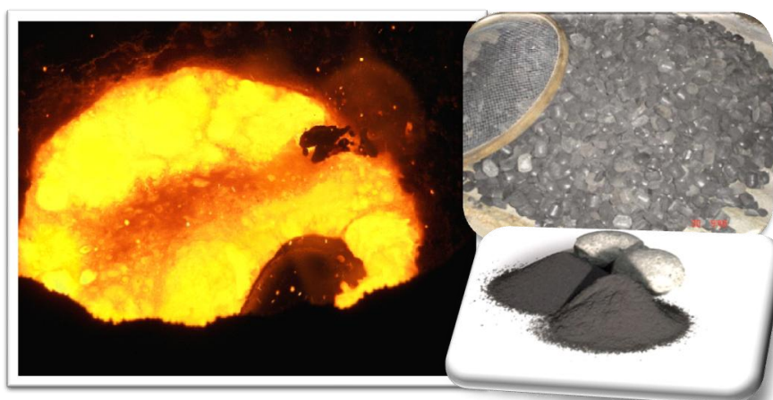
Figura 4.2 - Produtos para saturação e espumação da escória.
