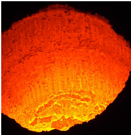
Figura 14 - Revestimento de panela com camada protetora de escória
