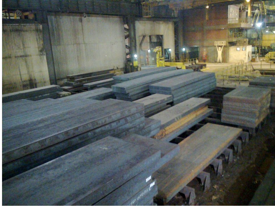
Figura 3 Leito de resfriamento de placas 2
