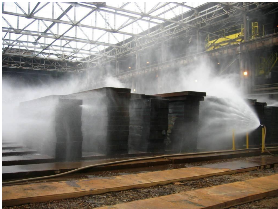
Figura 6 Leito de resfriamento de placas 3
