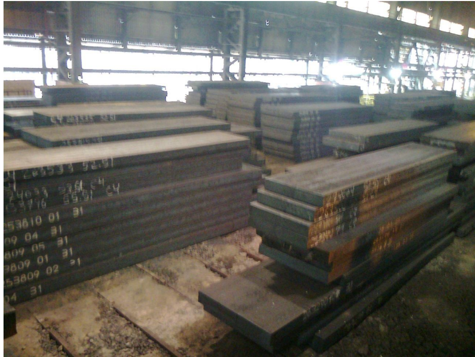
Figura 5 Leito de resfriamento de placas 1.
