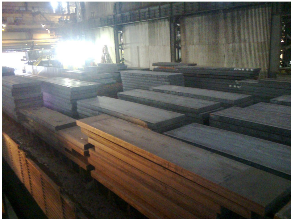
Figura 4 Leito de resfriamento de placas 2.
