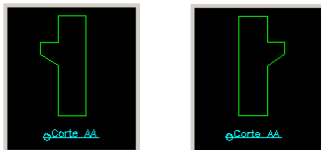
FIGURA A. 11 – Seções transversais de vigas VLS com posição espelhada ou não.
