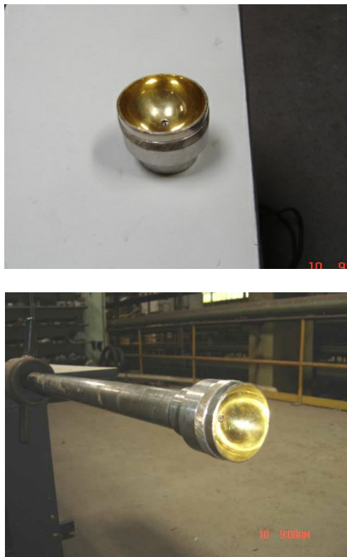
FIGURA 3.6 - Sensor e haste montada do sistema de medição de temperatura
