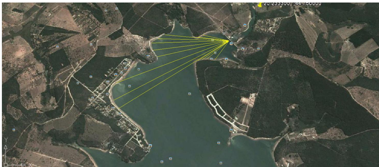
Figura 5.7 - Pontos ao longo do reservatório utilizados para o cálculo do fetch efetivo
