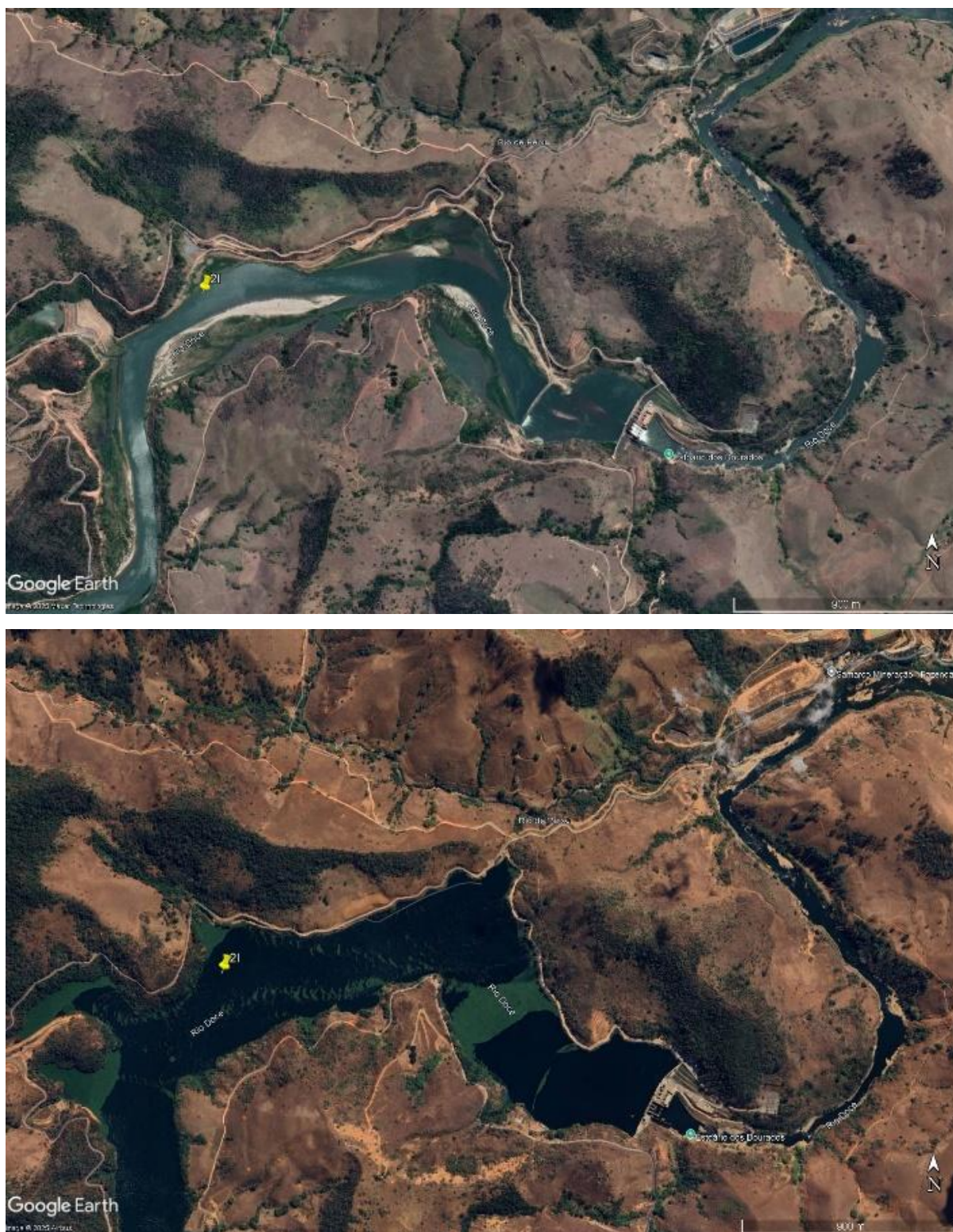
Figura 6 - Imagens de satélite do reservatório de Candonga: pré-enchimento do reservatório, durante a remoção de rejeitos (Junho/22) e pós-enchimento e remoção de rejeitos (Agosto/24). O marcador amarelo se refere a localização exata do ponto R. Fonte: Google Earth, 2024
