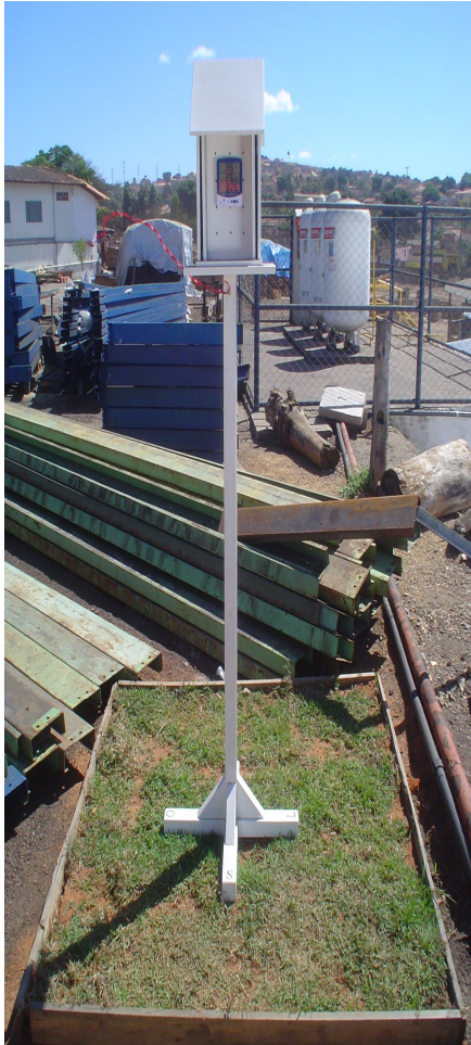
Foto 10: Abrigo meteorológico instalado na CasaMáxima Ind. e Com. Ltda
