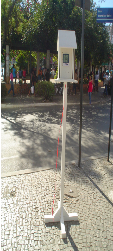
Foto 6: Abrigo meteorológico instalado na Praça Francisco Sales
