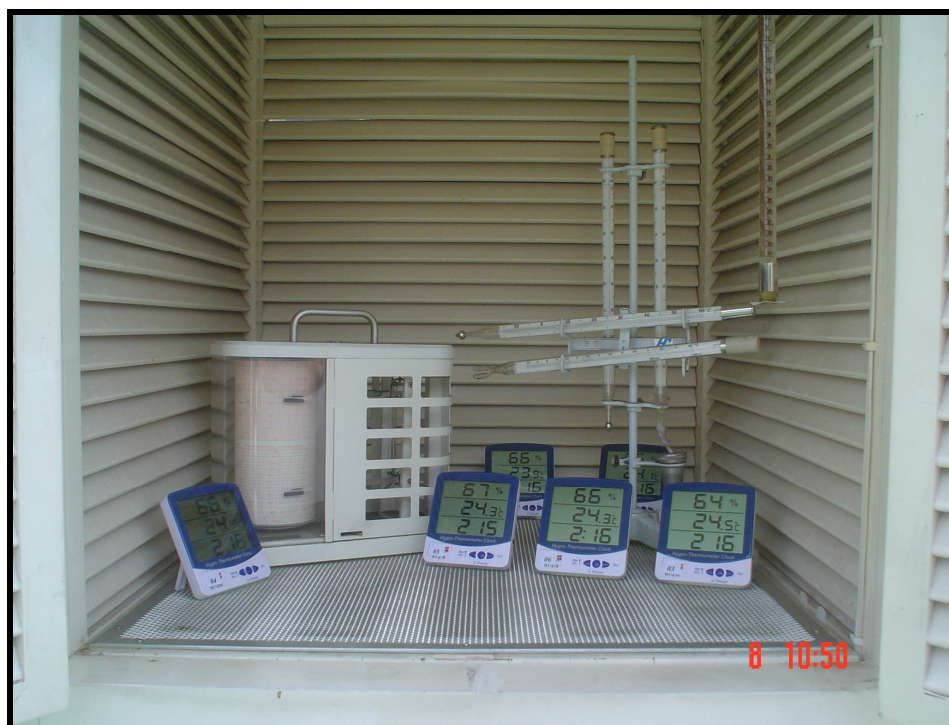
Foto 2 – Calibração dos termo-higrômetros no 5º Disme/ INMET
