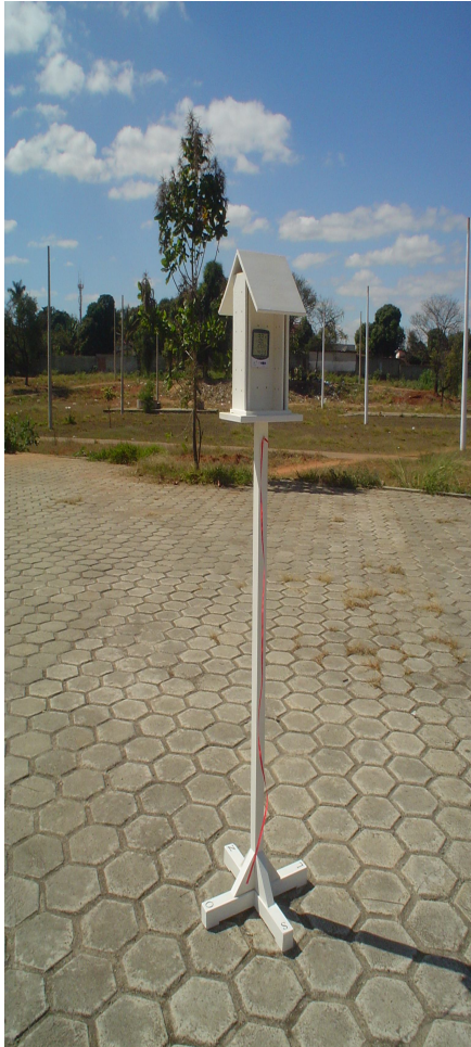
Foto 3: Abrigo meteorológico instalado na Avenida Antônio Olinto
