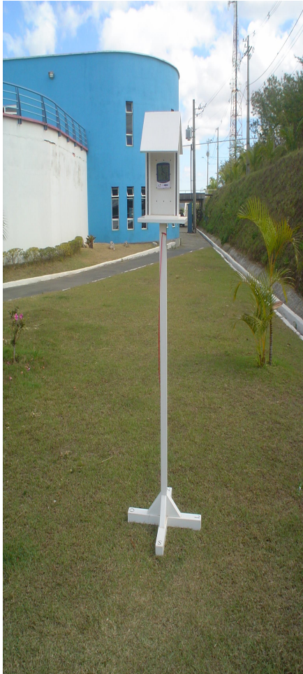
Foto 8: Abrigo meteorológico instalado no 25º Batalhão de Polícia Militar
