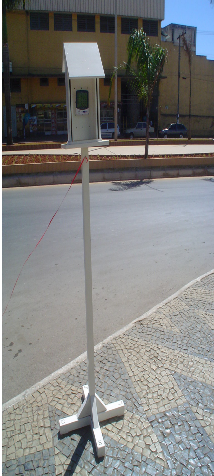
Foto 7: Abrigo meteorológico instalado na Praça da Rodoviária
