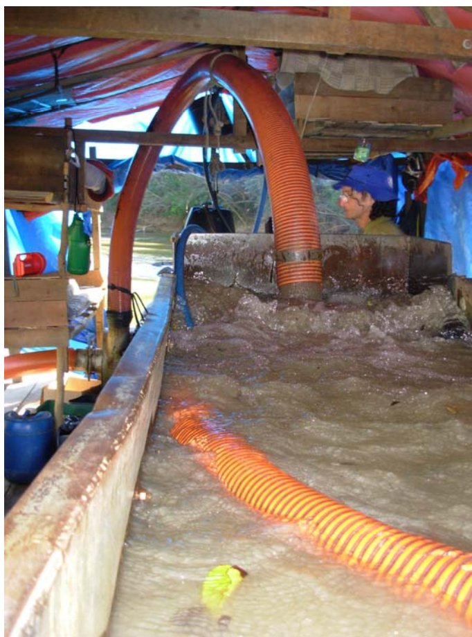
Foto 12: Jigue em funcionamento na parte interna da balsa de garimpo.
