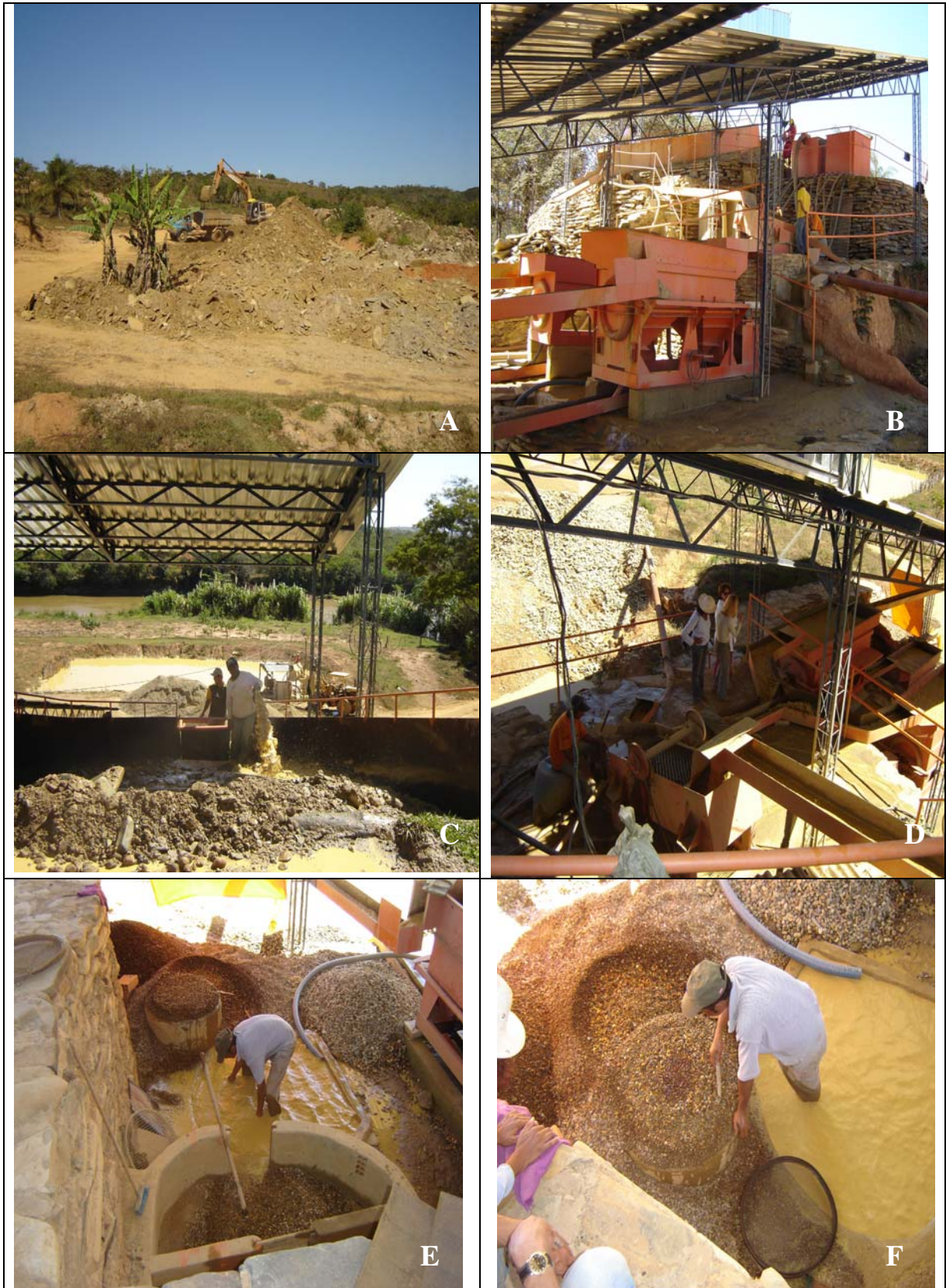
Figura 13: Diversos estágios dos serviços executados pela GAR Mineração. Cascalho sendo retirado e transportado para o jigge (A); lavagem e seleção do material (B e C); parte inferior do jigge (D); peneiramento manual da fração fina do material e apuração (E e F).
