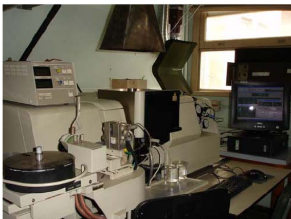
Figura 4-10: Fotografia do equipamento de AA empregado na caracterização das amostras dos experimentos desta dissertação de mestrado
