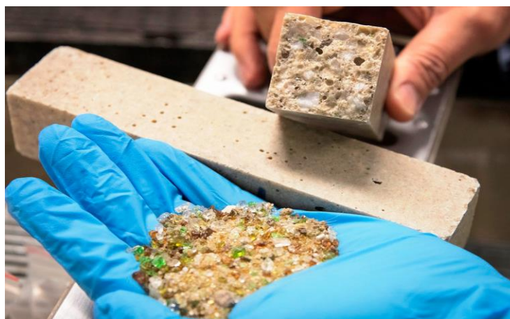
Figura 13: Modelo de concreto com resíduo de vidro moído
