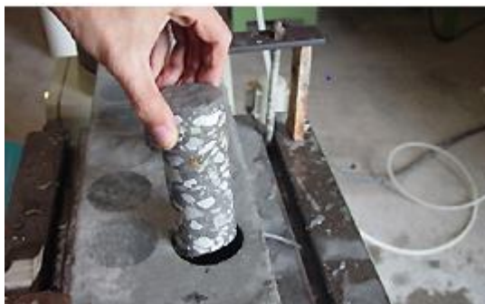
Figura 09: Corpo de prova compacto de concreto com cinza de casca de arroz
