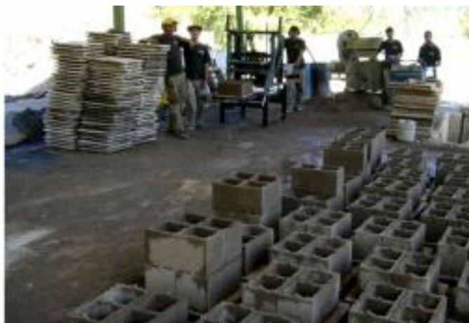
Figura 04: Fabricação do Ecobloco, Usina de Reciclagem do Estoril
