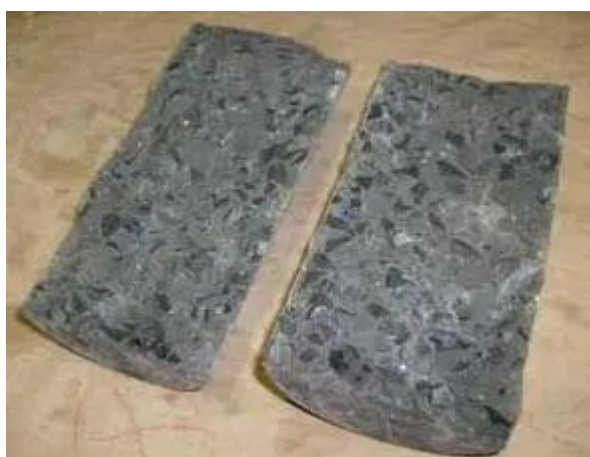
Figura 10: Exemplo corpo de prova concreto com resíduo de cinza de cana de açúcar
