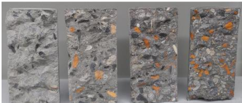
Figura 14: Corpos de prova de RCD em concreto
