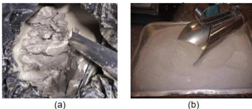
Figura 07: Resíduo do beneficiamento do mármore e granito: (a) lama e (b) seco em pó
