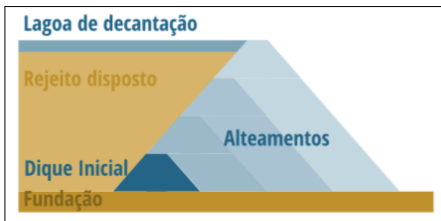
Figura 2 - Método de construção de barragem a jusante
