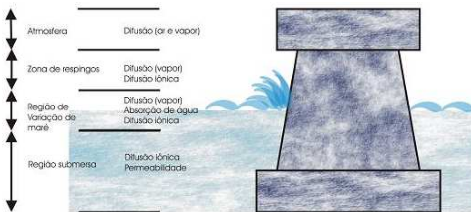
Figura 2.46: Atuação simultânea de diversos mecanismos de transporte em uma estrutura marítima. Fonte: Ferreira (1999) apud Missau (2004).
