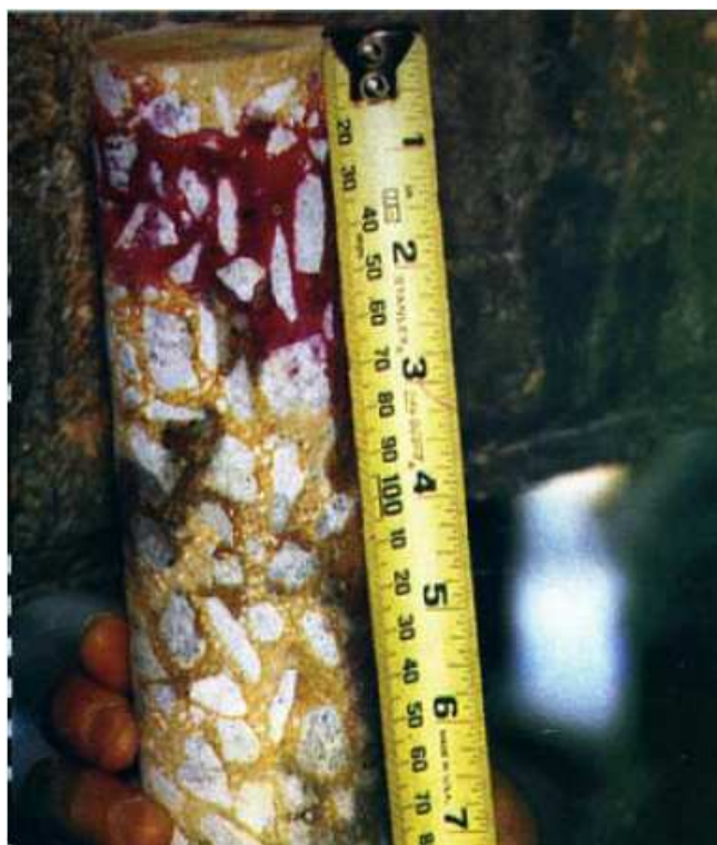
Figura 2.39: Fenolftaleína aplicada em corpo de prova. Fonte: Rocha (2005) apud Polito (2006).
